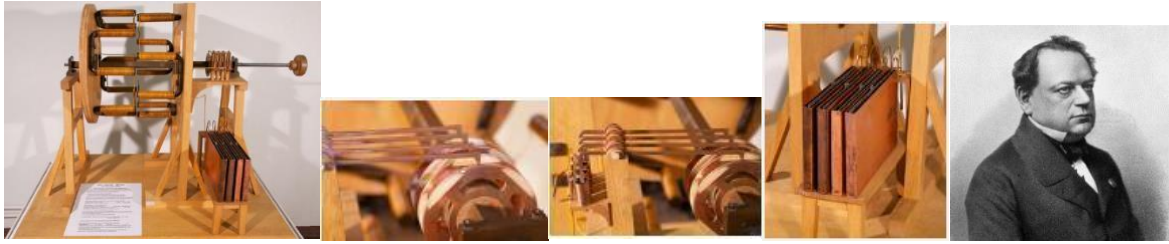
Εικόνα 11: Ο κινητήρας του Moritz Jacobi με τα εξαρτήματά του (α) ο μεταγωγέας, (β) οι βούρτσες και βάση βούρτσας, και (γ) η μπαταρία οξέος ψευδαργύρου και ο ίδιος ο Jacobi
