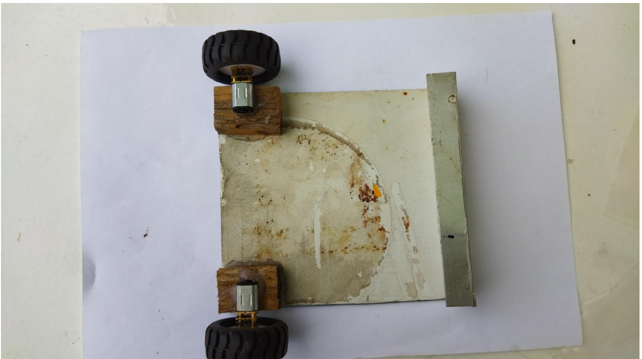
Εικόνα 20. Τοποθέτηση των κινητήρων στον σκελετό.
