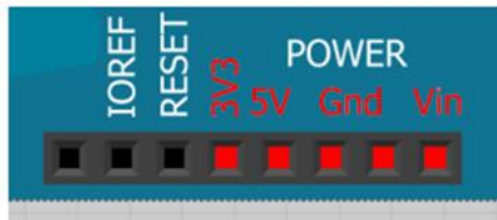
Εικόνα 2. Είσοδοι έξοδοι τροφοδοσίας Arduino Uno
