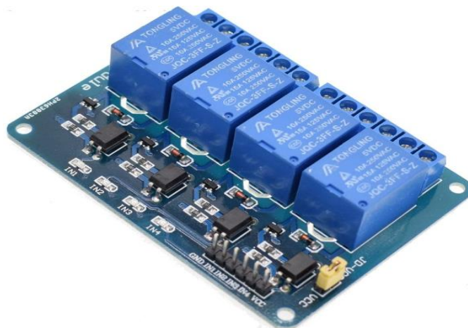
Εικόνα 24: ΡΕΛΕ ΤΕΣΣΑΡΩΝ ΚΑΝΑΛΙΩΝ
