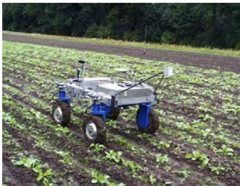
Εικόνα 4.1: Η ερευνητική αυτοκινούμενη πλατφόρμα API
