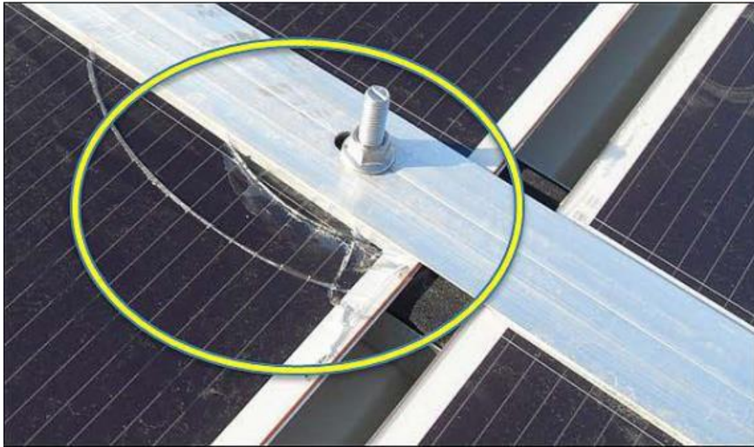
Εικόνα 33. Θραύση γυάλινου πλαισίου φωτοβολταϊκού λόγω υπερβολικής σύσφιξης βίδας (Πηγή: ΙΕΑ 2014 27 )
