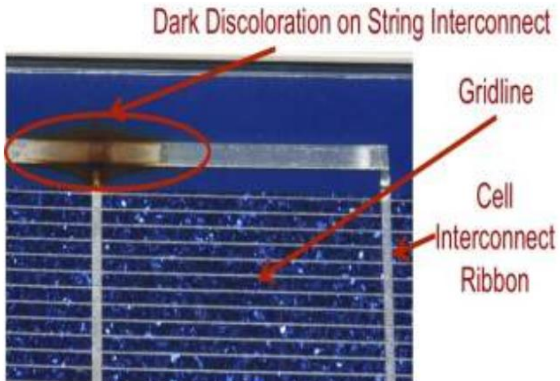
Εικόνα 41. Αποχρωματισμός του αγωγού πάνελ φωτοβολταϊκού λόγω υπερθέρμανσης (Πηγή: IEA 2014 27 )
