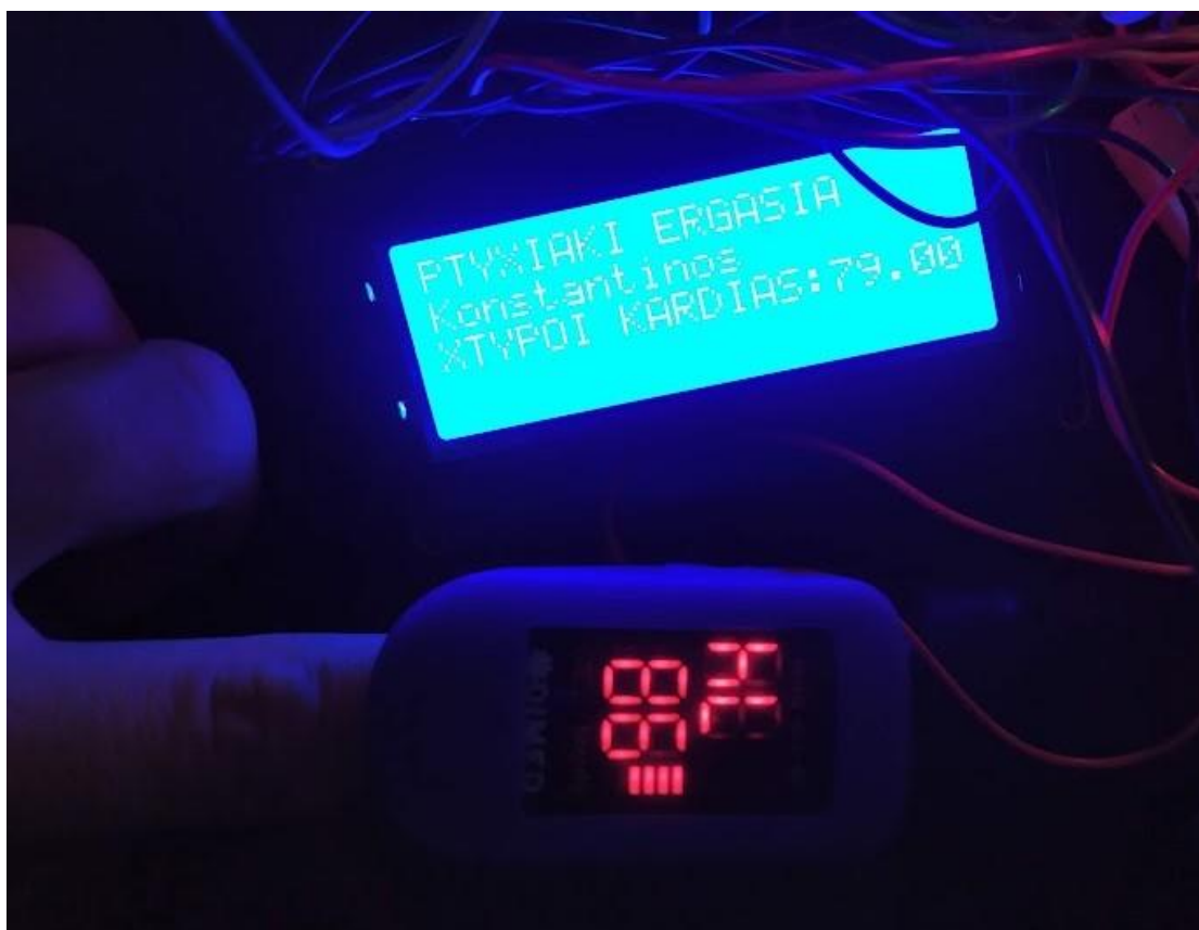
Εικόνα 45 : Σύγκριση με ένα παλμικό οξύμετρο της αγοράς
