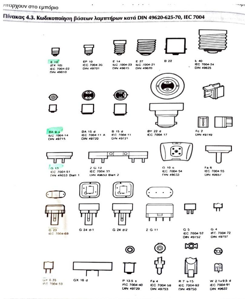
Εικόνα 6: Κωδικοποίηση βάσεων λαμπτήρων.[11]
