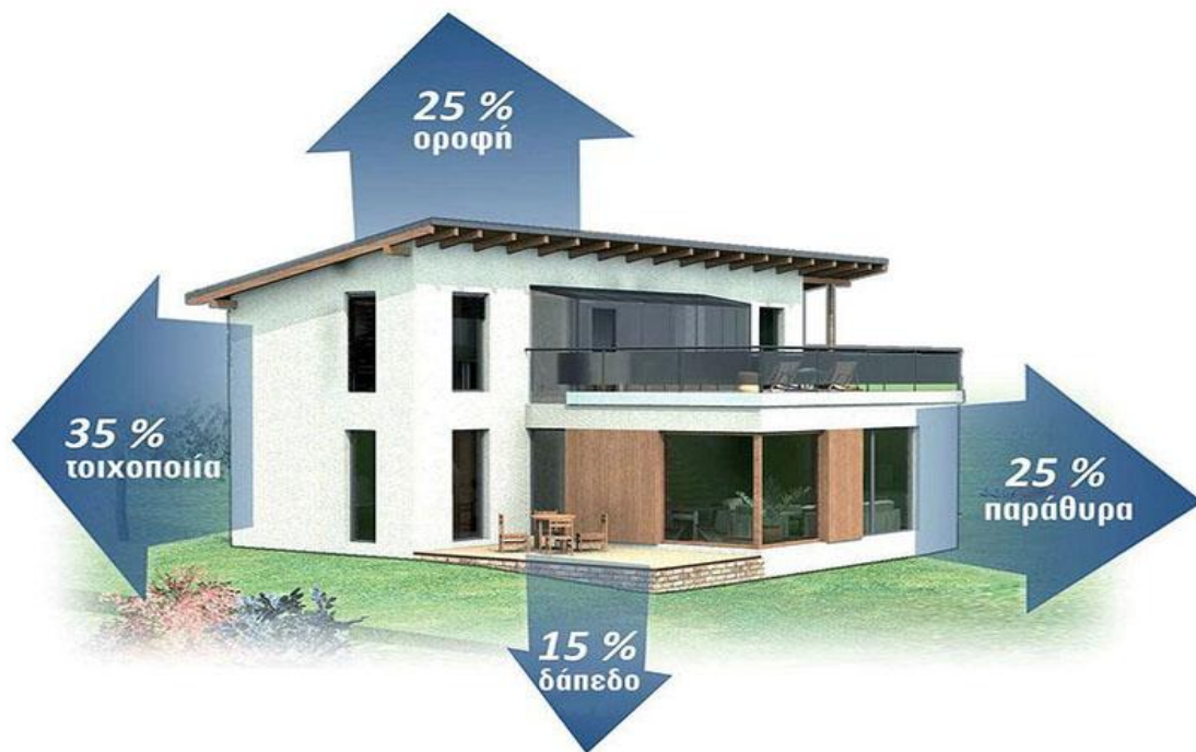
Εικόνα 4: Θερμικές απώλειες κτιριακού κελύφους. Πηγή: (ΠΙΚΡΑΚΙΣ)
