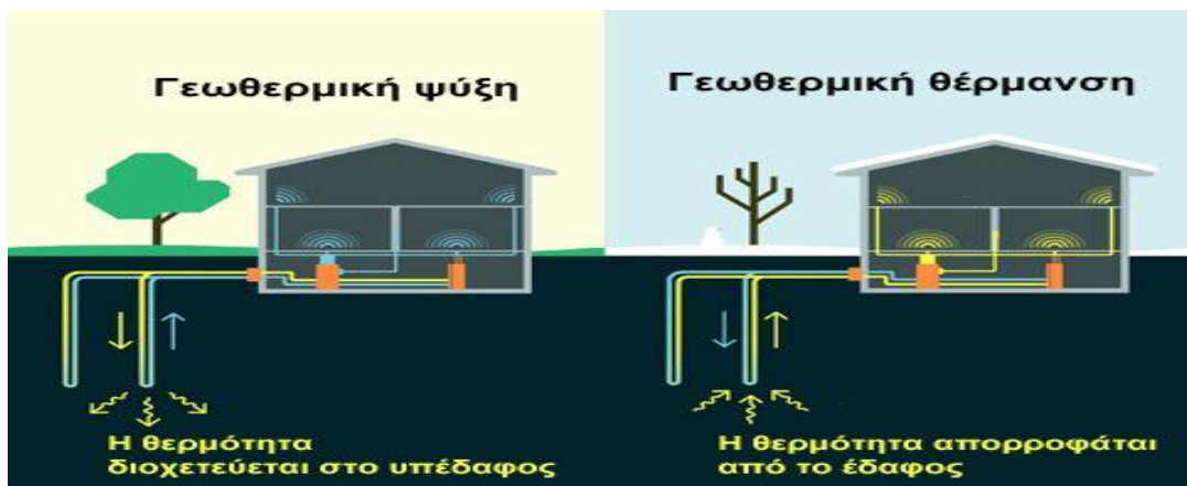
Εικόνα 16 Σύστημα γεωθερμικής θέρμανσης και ψύξης.
