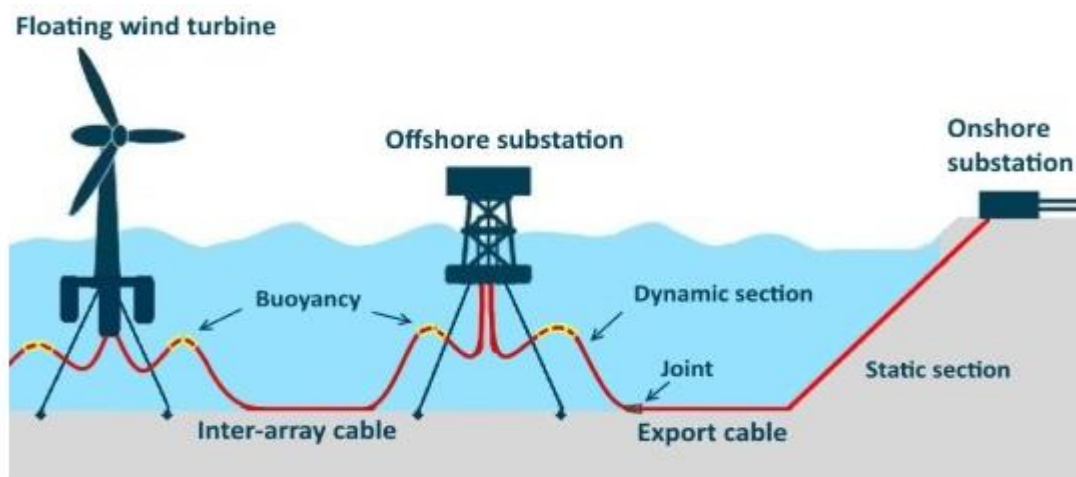
Εικόνα 20: Κύριο σύστημα λειτουργίας θαλάσσιας ανεμογεννήτριας (Πηγή : https://www.sciencedirect.com/ )
