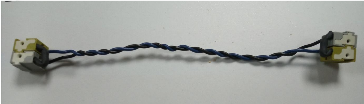
Εικόνα 39: Καλώδιο bus dS485 σύνδεσης μετρητή με server
