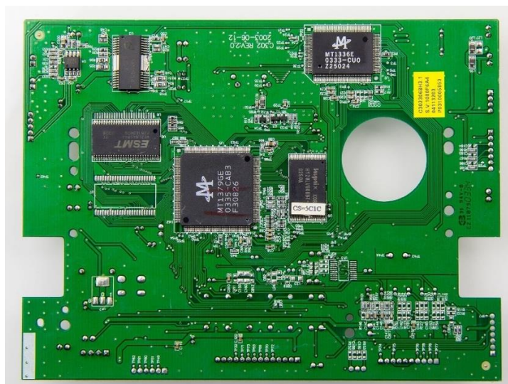
Εικόνα 1 Αναπαράσταση πλακέτας κυκλώματος πλακέτας που χρησιμοποιείται σε DVD player.
