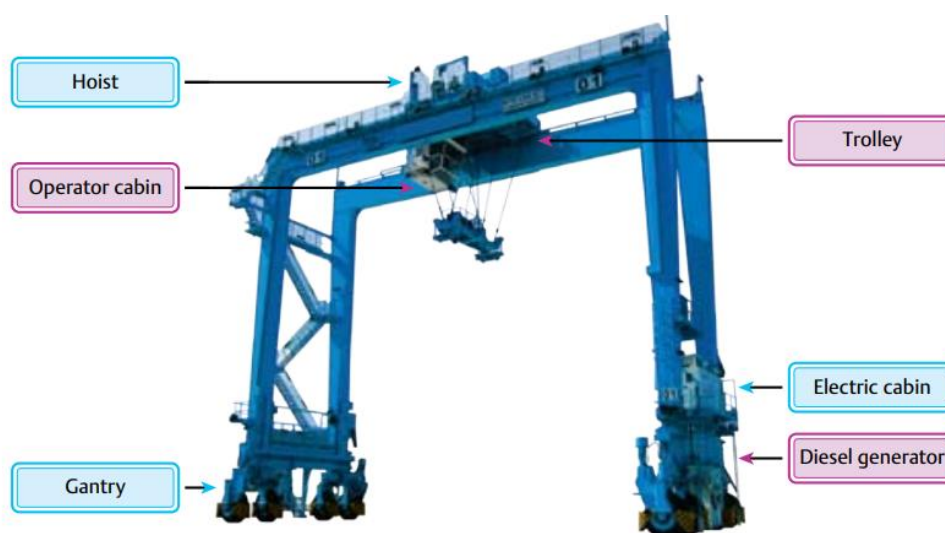
Figure 7. Χαρακτηριστικά ενός RTG γερανού.
