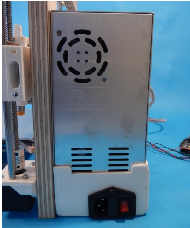
Εικόνα 91: Καλωδίωση και Εγκατάσταση Τροφοδοτικού 3
