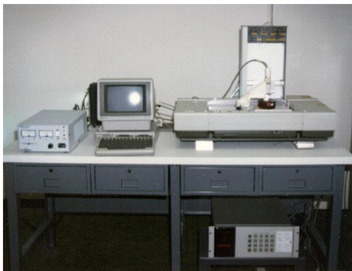
Εικόνα 1: Ο πρώτος εκτυπωτής SLA (πηγή: https://www.sculpteo.com/en/3d-learning-hub/basics-of-3d-printing/the-history-of-3d-printing/ )
