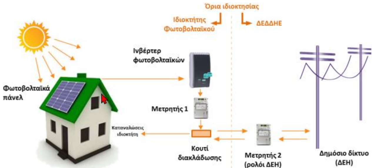
Εικόνα 1.3 Net Metering - Σχεδιάγραμμα συνδεσμολογίας και τρόπος λειτουργίας (Πηγή: https://www.oleng.eu/net-metering/#%CE%A4%CE%B9%20%CE%B5%CE%AF%CE%BD%CE%B1%CE%B9%20%CE%B7%20%CE%B1%CF%85%CF%84%CE%BF%CF%80%CE%B1%CF%81%CE%B1%CE%B3%CF%89%CE%B3%CE%AE )
