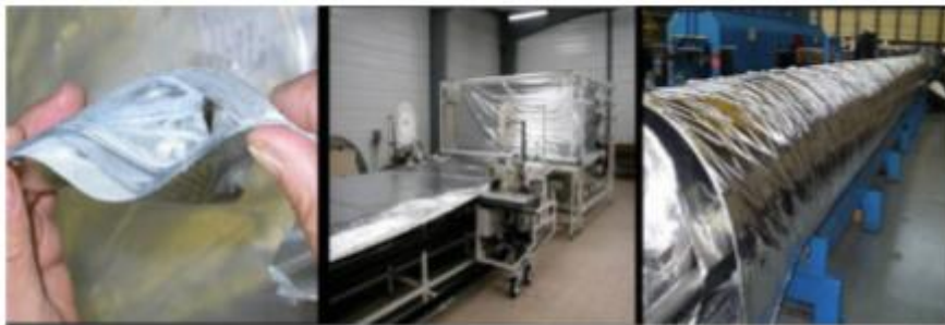
Εικόνα 5: Το σύστημα MLI για τους κρυοστατικούς μαγνήτες μεγάλου επιταχυντή αδρονίων (LHC).
