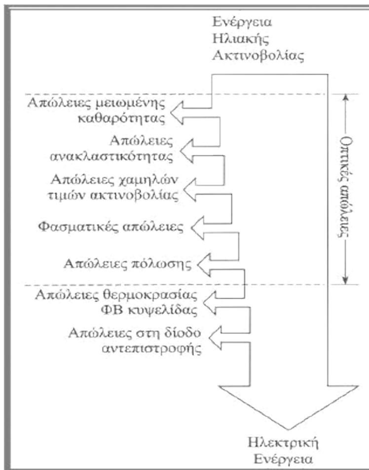
Σχήμα 14: Διάγραμμα για τη ροή ενέργειας σε Φ/Β πλαίσιο
