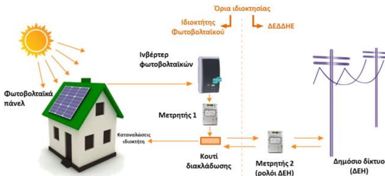
Σχήμα 4.41 – Σχηματικό διάγραμμα συνδεσμολογίας και τρόπος λειτουργίας του Net Metering [87]
