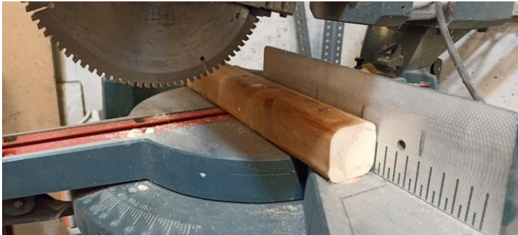
Εικόνα 71 Φωτογραφία από την διαδικασία κοπής του καδρονιού.
