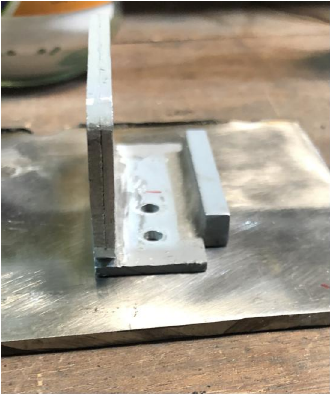
Εικόνα 20: Συγκόλληση της βάσης στερέωσης του σερβοκινητήρα (πλάγια όψη).
