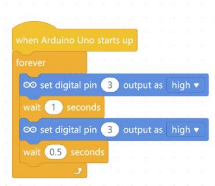
Εικόνα 9: Παράδειγμα του block-based coding. (Πηγή: createmakers 10 )
