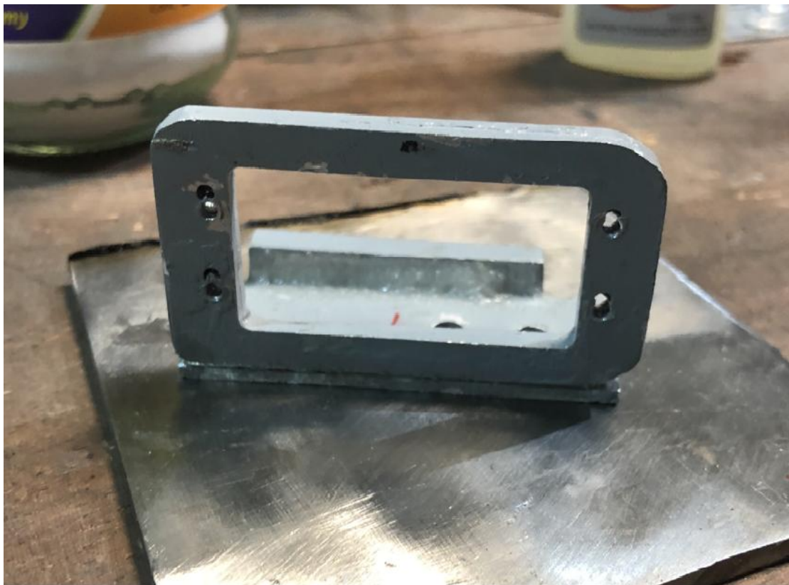
Εικόνα 19: Συγκόλληση της βάσης στερέωσης του σερβοκινητήρα (μπροστινή όψη).
