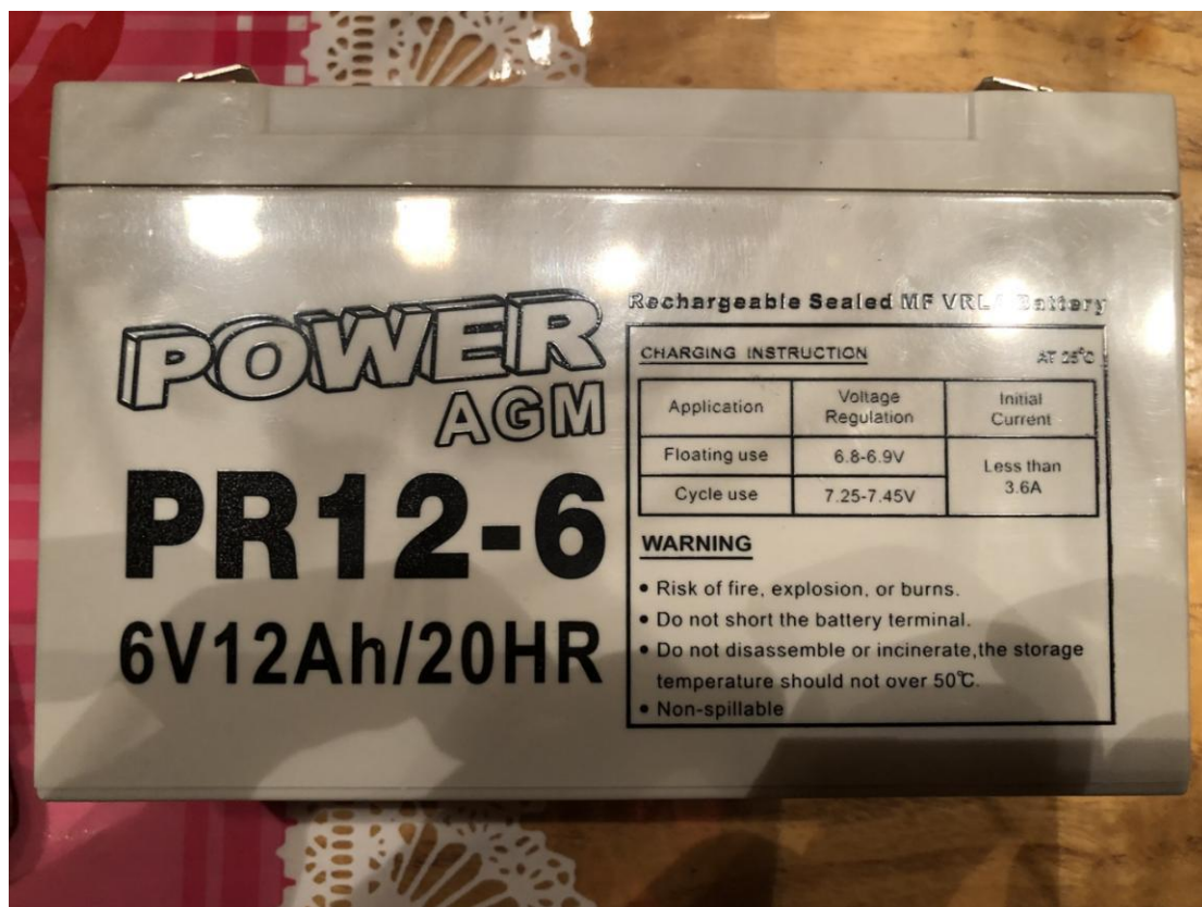
Εικόνα 33: Η μπαταρία για την τροφοδοσία των σερβοκινητήρων.
