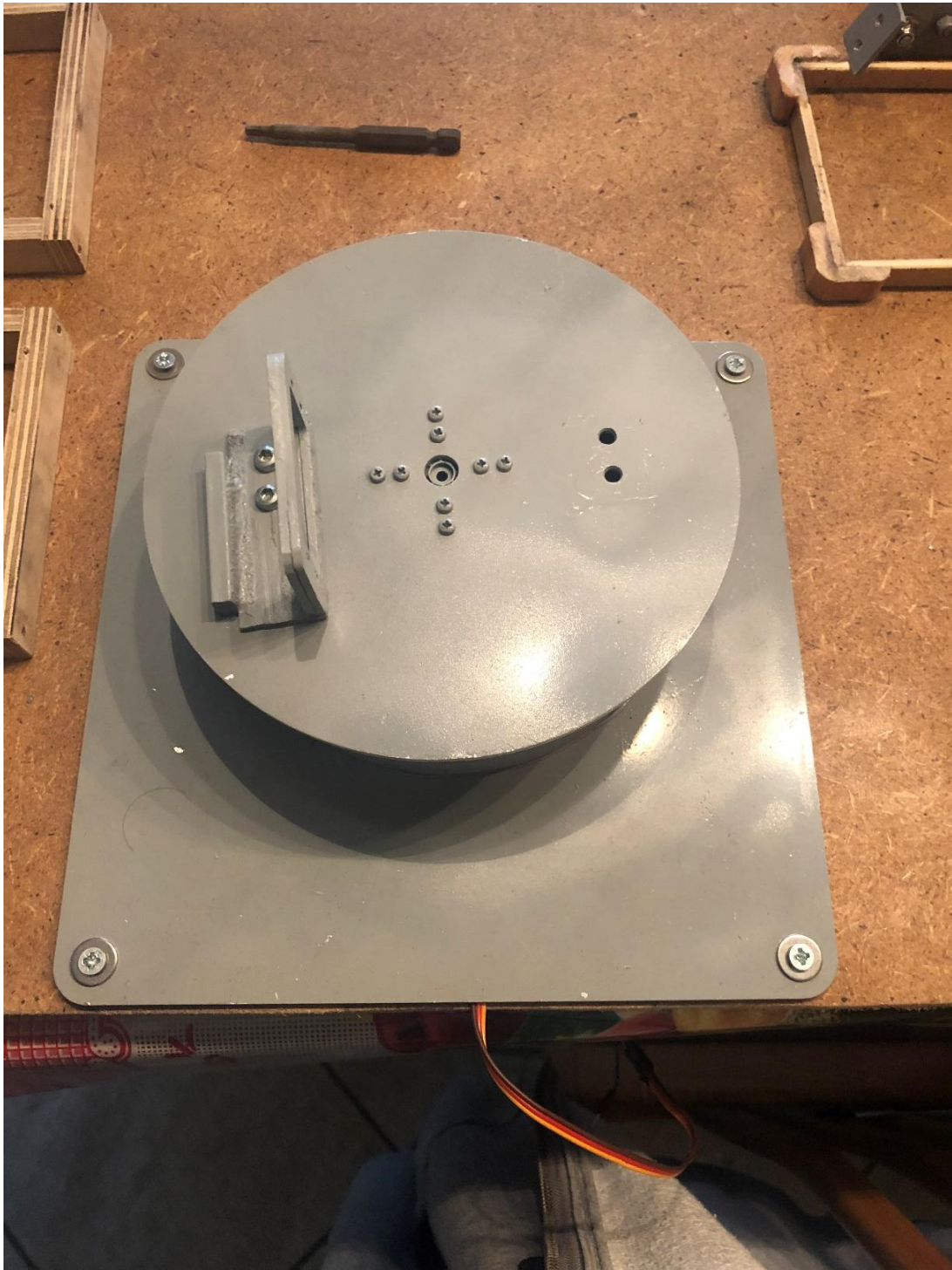
Εικόνα 36: Τοποθέτηση περιστρεφόμενης βάσης βραχίονα και βάσης σερβοκινητήρα.
