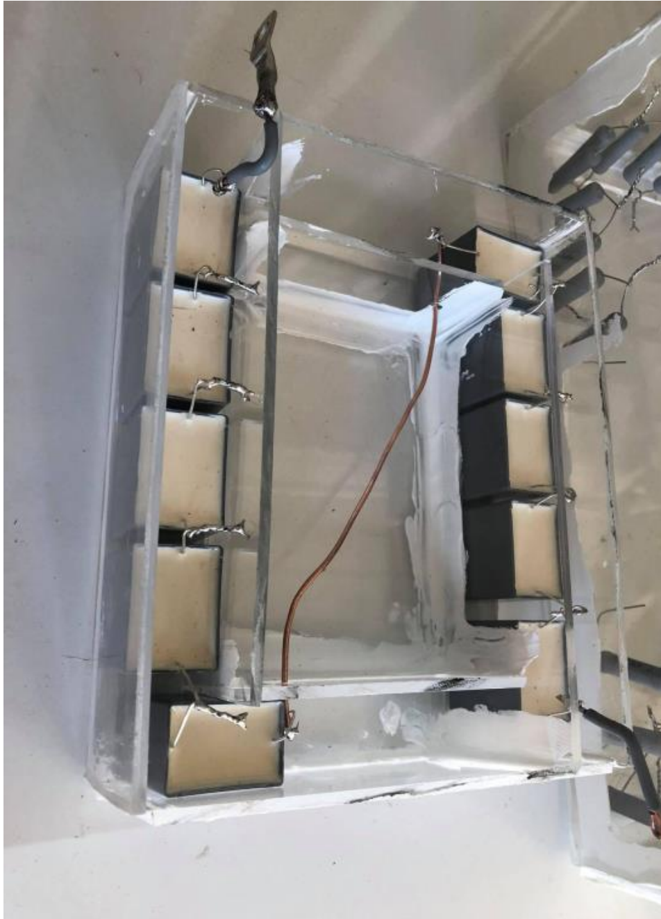
Εικόνα 2.4.2 Πυκνωτές 220 nF σε σειρά (22 nF συνολικά) σε κουτί από Plexiglas [6].
