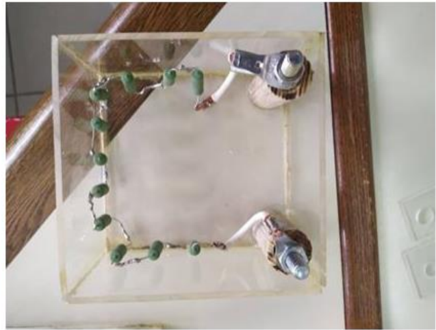
Εικόνα 2.5.3 Αντίσταση 110 Ω (11 αντιστάσεις των 10 Ω συνδεδεμένες σε σειρά) [5].
