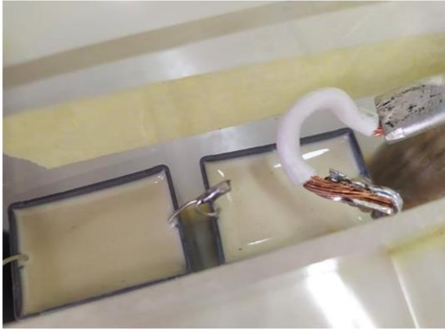
Εικόνα 2.4.3 Σύνδεση πυκνωτών 220 nF σε σειρά με ακροδέκτη [5].
