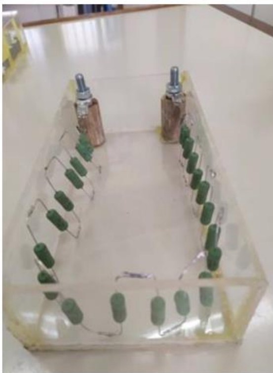
Εικόνα 2.5.2 Αντίσταση 220\ \Omega (22 αντιστάσεις των 10\ \Omega συνδεδεμένες σε σειρά) [5].
