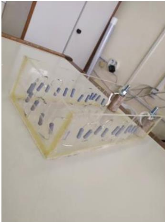
Εικόνα 2.5.1 Αντίσταση 2.9\text{ k}\Omega (29 αντιστάσεις των 100\ \Omega συνδεδεμένες σε σειρά) [5].
