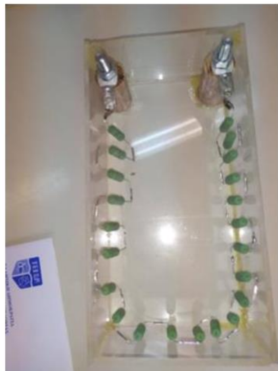
Εικόνα 2.5.2 Αντίσταση 220\ \Omega (22 αντιστάσεις των 10\ \Omega συνδεδεμένες σε σειρά) [5].
