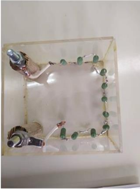
Εικόνα 2.5.3 Αντίσταση 110 Ω (11 αντιστάσεις των 10 Ω συνδεδεμένες σε σειρά) [5].
