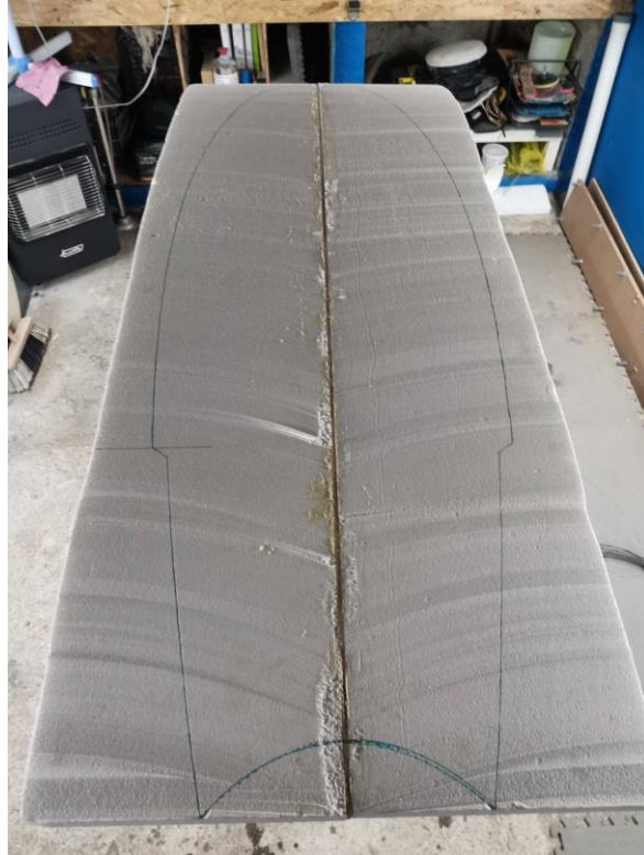
Εικόνα 30 τοποθέτηση περιγράμματος σανίδας στον αφρό.
