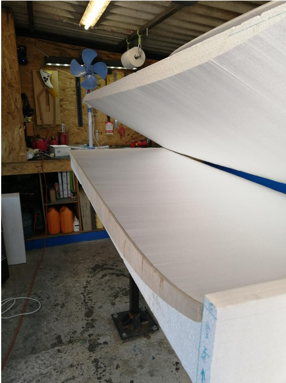
Εικόνα 27 άνω πλευρά, κοπή hot wire cutting.
