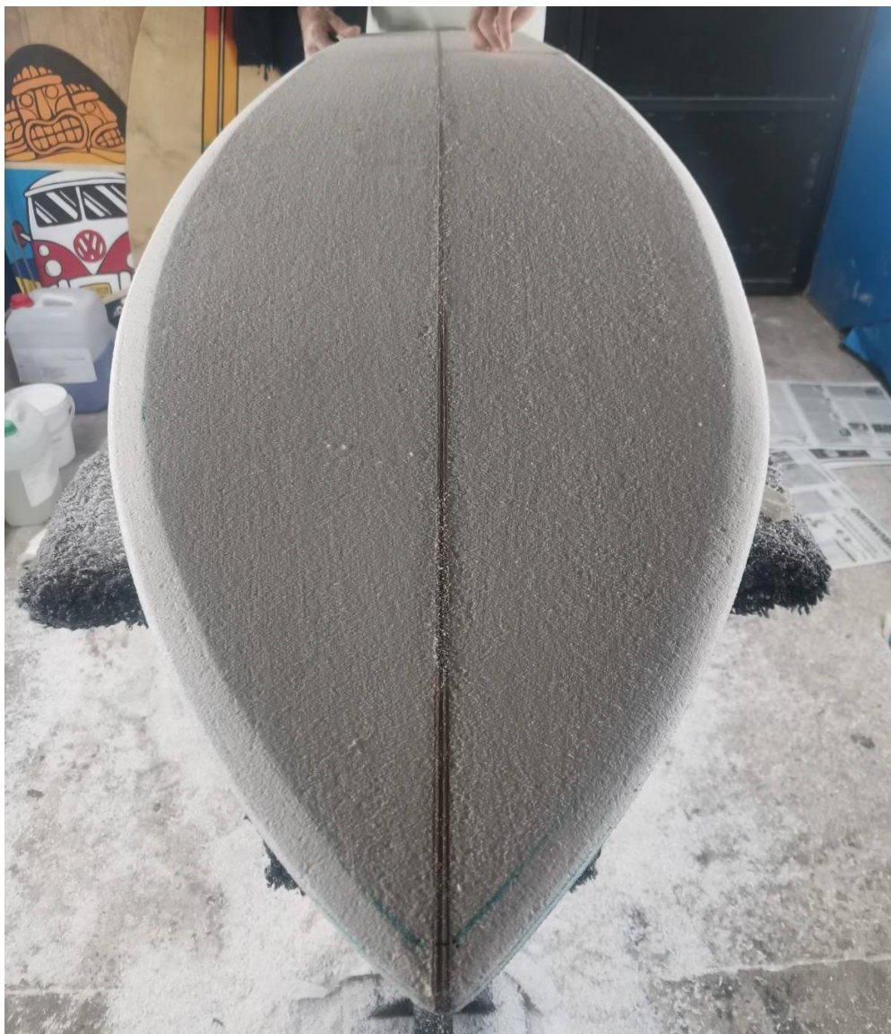
Εικόνα 36 σχεδιασμός με μαλακό μολύβι και αφαίρεση υλικού.
