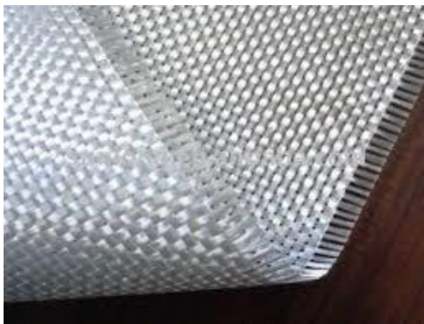
Εικόνα 24 πλέξη από ίνες υάλου.
