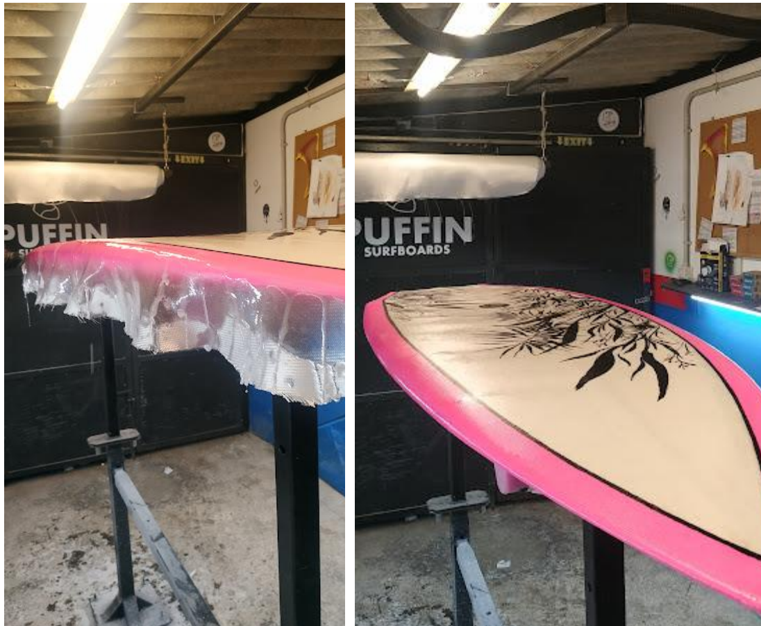
Εικόνα 44,45 τοποθέτηση fiberglass 8oz με ρητίνη
