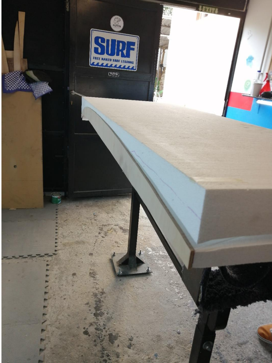
Εικόνα 26 τοποθέτηση του προτύπου rocker στον αφρό.
