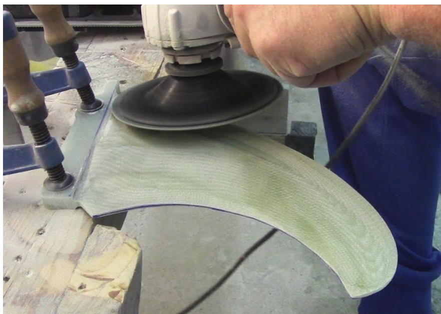
Εικόνα 17 μορφοποίηση πτερυγίου με περιστροφικό λειαντήρα .
