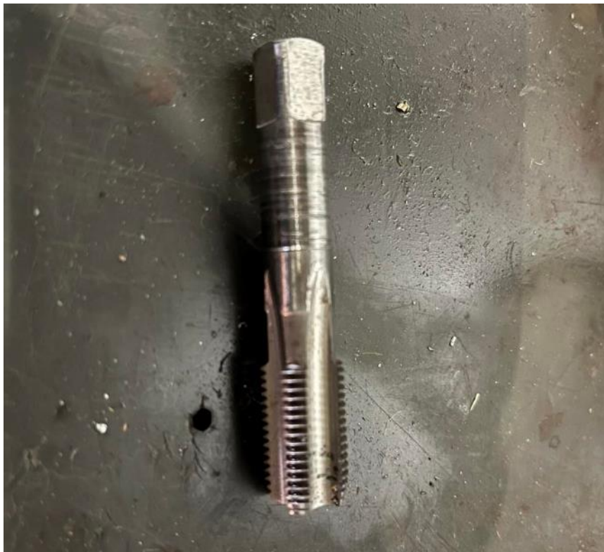
Εικόνα 67: Κολαούζο \frac{1}{4} " για την δημιουργία σπειρώματος
