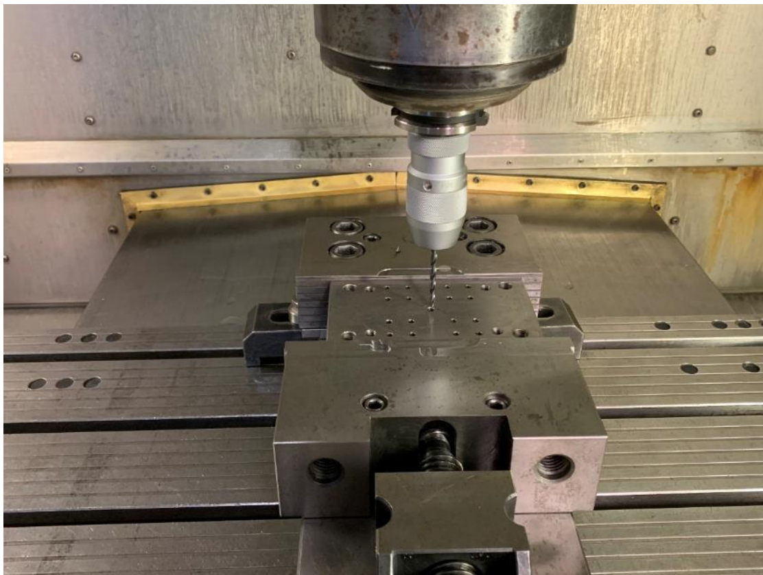
Εικόνα 62: Η μέγγενη για την συγκράτηση του δοκιμίου στην κατασκευή του εξωλκέα πάνω στη βάση της εργαλειομηχανής cnc
