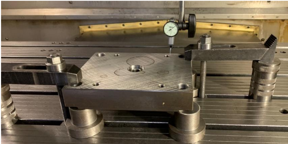
Εικόνα 63: Μέτρηση παραλληλότητας με το ωρολογιακό μικρόμετρο
