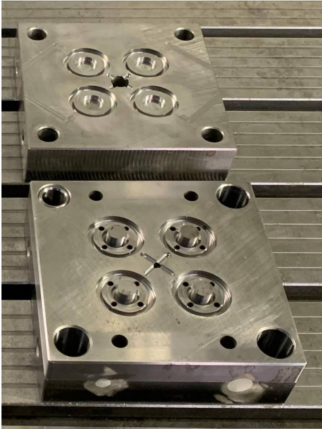
Εικόνα 16: Οι δύο πλάκες μορφής του καλουπιού. Οι δύο όψεις των πλακών τοποθετούνται Η πάνω πλάκα τοποθετείται (ανάποδα από την φωτογραφία) πάνω από την κάτω ώστε να βλέπει η μία την άλλη. Στο κέντρο διακρίνονται τα κανάλια έγχυσης του υλικού. Κεντρικά σε κάθε κοιλότητα διακρίνεται το ένθετο, που παίζει το ρόλο του πυρήνα. Οι πυρήνες που διακρίνονται στην κάτω πλάκα είναι τα ένθετα που κατασκευάζονται χωριστά, ώστε εάν χρειαστούν αλλαγές στην διάσταση του πυρήνα (διάμετρος άξονα ρόδας), να μην χρειαστεί να αλλάξει όλη η πλάκα μορφής του καλουπιού.
