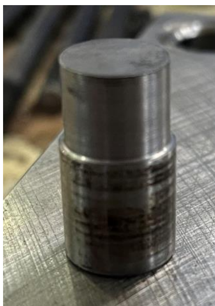
Εικόνα 17: Το ένθετο που παίζει το ρόλο του πυρήνα στο καλούπι
