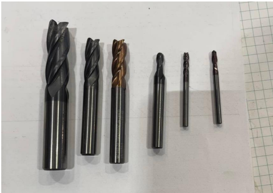
Εικόνα 65: Τα κονδύλια (από αριστερά) Flat 12, Flat 8, Ball 8 r0,5, Ball 4, Flat 3, Ball 3
