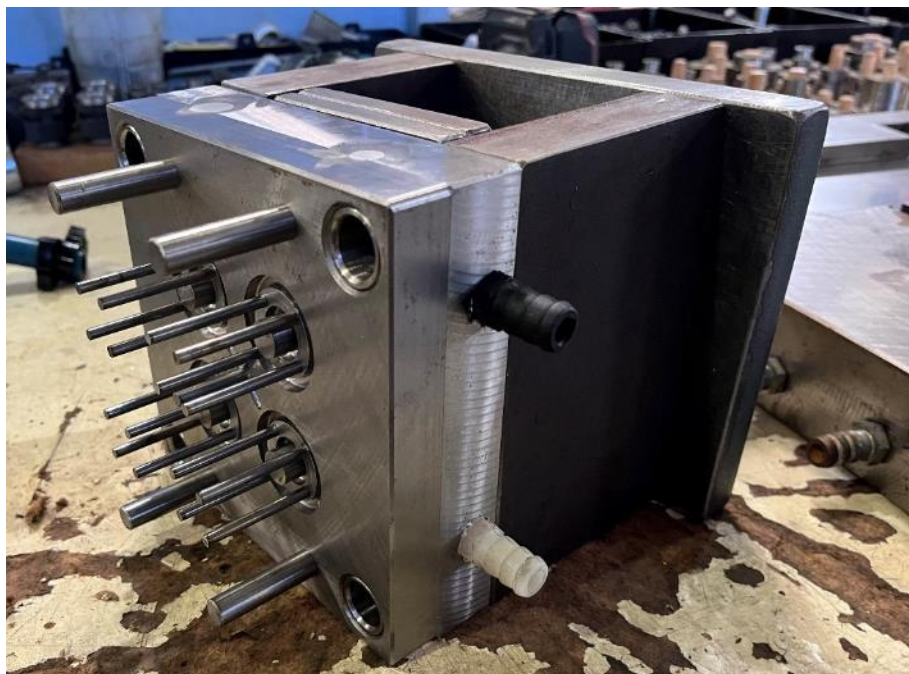
Εικόνα 25: Συναρμολογημένο το κινητό μέρος του καλουπιού. Ο εξολκέας είναι την άνω θέση του (ενεργοποιημένος), οπότε διακρίνονται οι ντίξες που βγαίνουν από τις αντίστοιχες οπές της πλάκας μορφής.
