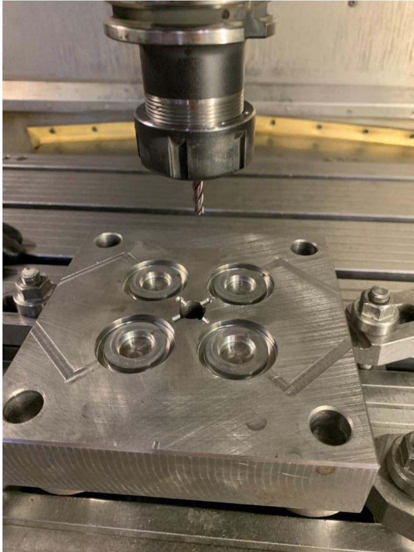
Εικόνα 71: Η πλάκα μορφής του σταθερού μέρους μετά το τέλος της κατεργασίας της στην εργαλειομηχανή cnc. Από πάνω διακρίνεται το τσοκ συγκράτησης του κοπτικού εργαλείου και το κονδύλι flat 12
