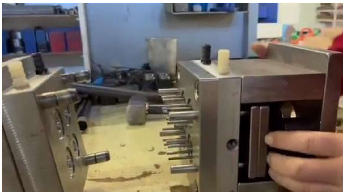
Εικόνα 19: Το ολοκληρωμένο καλούπι, πριν τοποθετηθεί στην μηχανή. Αριστερά το σταθερό μέρος. Διακρίνονται οι τρεις από τις τέσσερις κολώνες κεντραρίσματος στις γωνίες της πλάκας μορφής. Δεξιά το κινητό μέρος. Ο εξοκλέας είναι στην θέση απομάκρυνσης των τεμαχίων. Διακρίνονται οι δεκαέξι ντίζες για την απομάκρυνση των τεμαχίων και περιμετρικά οι τέσσερις ντίζες επαναφοράς του εξοκλέα. Στο επάνω μέρος διακρίνονται οι πλαστικοί σύνδεσμοί για την κυκλοφορία του ψυκτικού υγρού. Αντίστοιχα υπάρχουν και από την άλλη μεριά.
