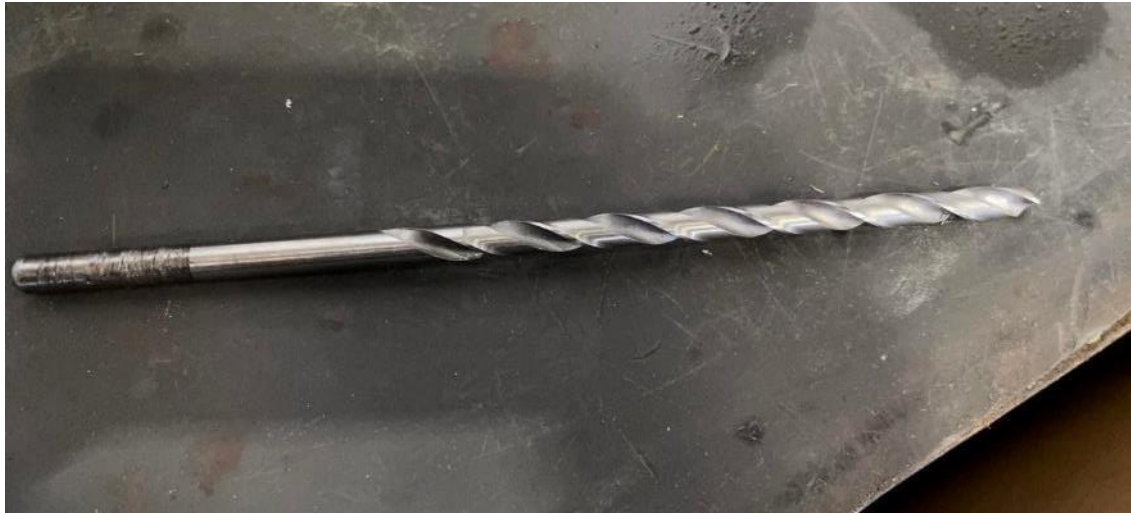
Εικόνα 66: Τρυπάνι \varnothing 8 για το άνοιγμα των οπών των ψυκτικών καναλιών (εσωτερική διάμετρος)
