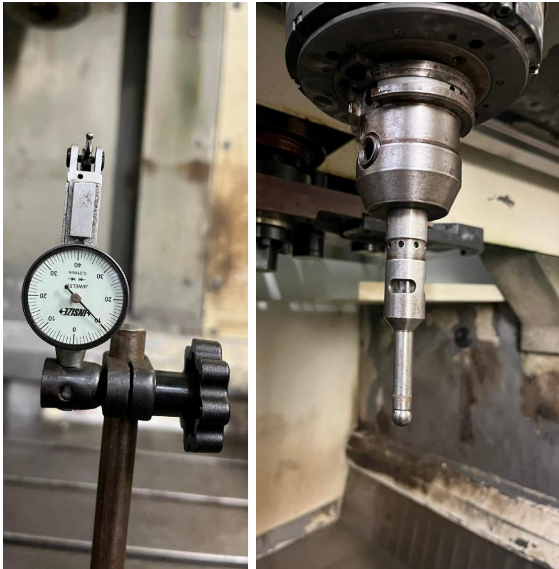
Εικόνα 68: Το ωρολογιακό μικρόμετρο και το touch probe της εργαλειομηχανής CNC
