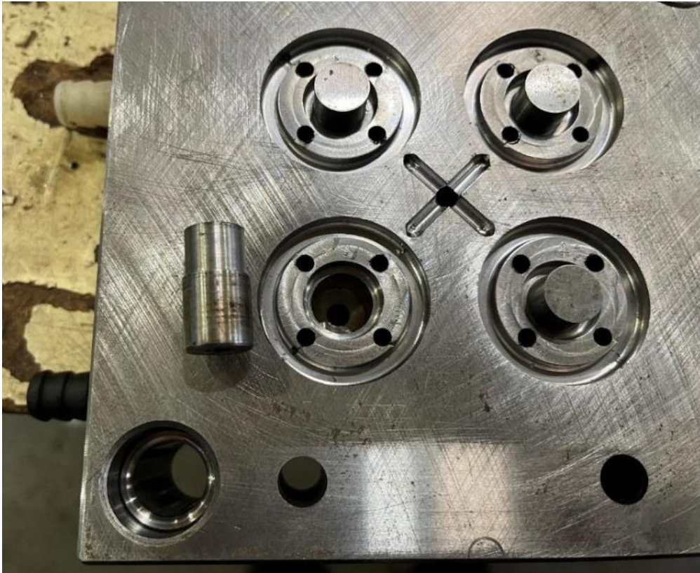
Εικόνα 24: Το τελικό εξάρτημα της πλάκας μορφής του κινητού μέρους και ένα από τα ένθετα (πυρήνες). Στις τρεις κοιλότητες υπάρχουν περασμένα τα ένθετα. Στην τέταρτη διακρίνεται η οπή στο κέντρο για τον άξονα στήριξης του ένθετου
