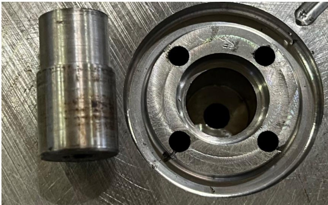
Εικόνα 34: Το ένθετο δίπλα σε μία από τις κοιλότητες της πλάκας μορφής. Διακρίνεται η οπή με την κοιλίωση στο κάτω μέρος του ένθετου
