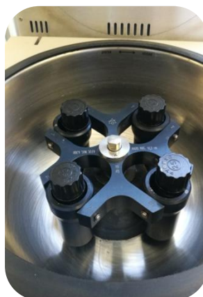
Εικόνα 3.2.1.6 (β) Εσωτερικό της φυγόκεντρος, δοκιμαστικοί σωλήνες με ευρύ στόμιο και βιδωτό πώμα, Πηγή: Προσωπικό αρχείο
