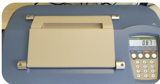
Εικόνα 3.2.1.7 (γ) Πολωσίμετρο, Πηγή: Προσωπικό αρχείο
