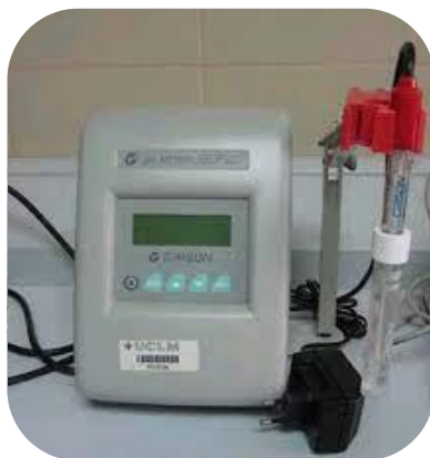
Εικόνα 3.2.1.1 (α) Πεχάμετρο CRISON GLP 22, Πηγή:
