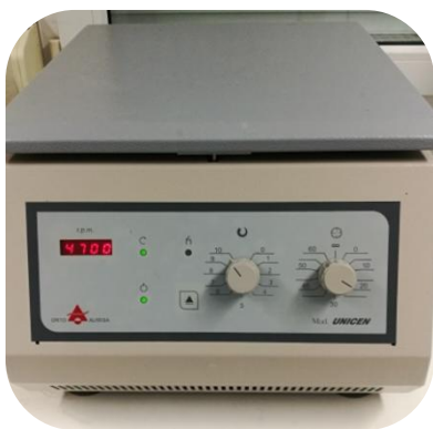
Εικόνα 3.2.1.6 (α) Φυγόκεντρος, Πηγή: Προσωπικό αρχείο
