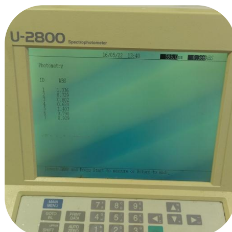
Εικόνα 3.2.2.4 (ζ) Φασματοφωτόμετρο διπλής δέσμης με αποτυπωμένες τις τιμές απορρόφησης του κάθε δείγματος στα 595 nm, Πηγή: Προσωπικό αρχείο
