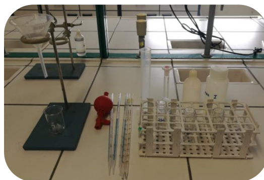
Εικόνα 3.2.2.5 (β) 2 στατώ, δακτύλιος με στέλεχος, διαχωριστικό χωνί, ποτήρι ζέσεως των 50 ml, πουάρ, 2 σιφόνια του 1 ml, 3 σιφόνια των 5 ml, ογκομετρικός κύλινδρος των 50 ml, ογκομετρική φιάλη των 50 ml, διάλυμα Carrez I, διάλυμα Carrez II, 3 δοκιμαστικοί σωλήνες των 15 ml, Πηγή: Προσωπικό αρχείο
