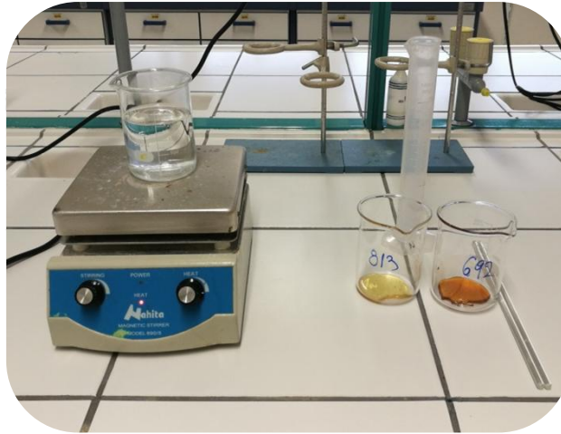
Εικόνα 3.2.1.1 (β) Θερμαντική πλάκα, ογκομετρικός κύλινδρος, ποτήρια ζέσεως, γυάλινη ράβδος, Πηγή: Προσωπικό αρχείο
