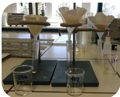
Εικόνα 3.2.2.5 (α) 2 στατώ, 3 δακτύλιοι με στελέχους, 3 διαχωριστικά χωνιά, 3 διηθητικά χαρτιά, 3 δοκιμαστικοί σωλήνες, 3 ποτήρια ζέσεως των 50 ml, Πηγή: Προσωπικό αρχείο
