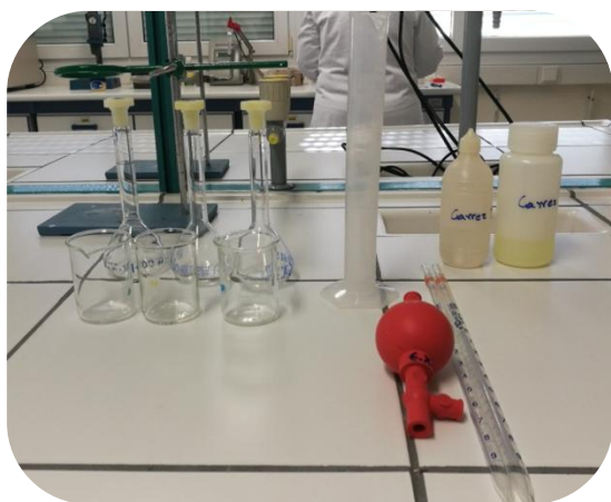
Εικόνα 3.2.1.7 (α) 3 ποτήρια ζέσεως των 100 ml, 3 ογκομετρικές φιάλες των 100 ml, ογκομετρικός κύλινδρος των 100 ml, πουάρ, δύο σιφόνια των 10 ml, διάλυμα Cagez I, διάλυμα Cagez II, Πηγή: Προσωπικό αρχείο
