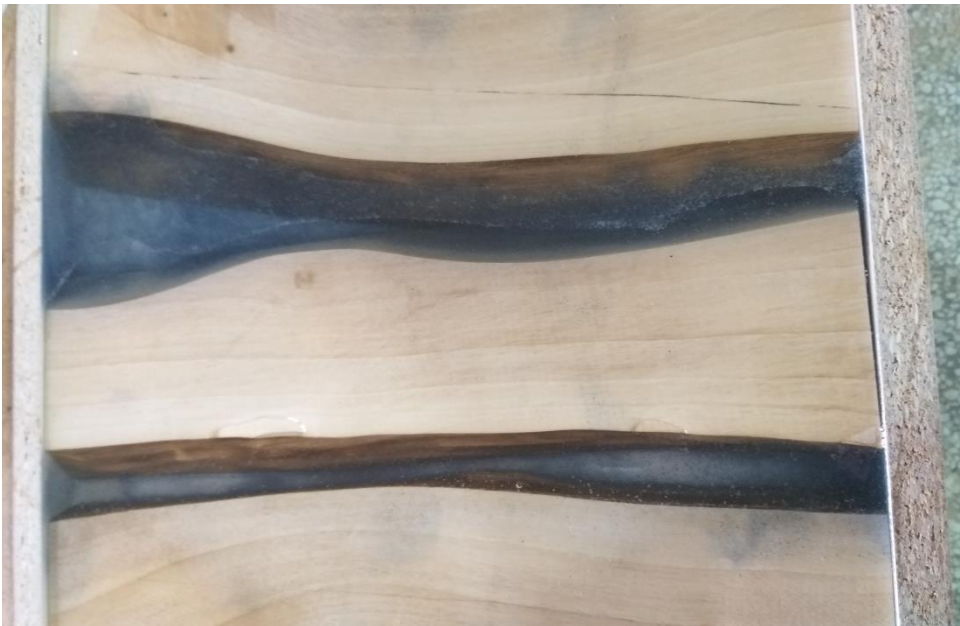
Εικόνα 31: Ολοκληρωμένο καλούπι με την ρητίνη.
