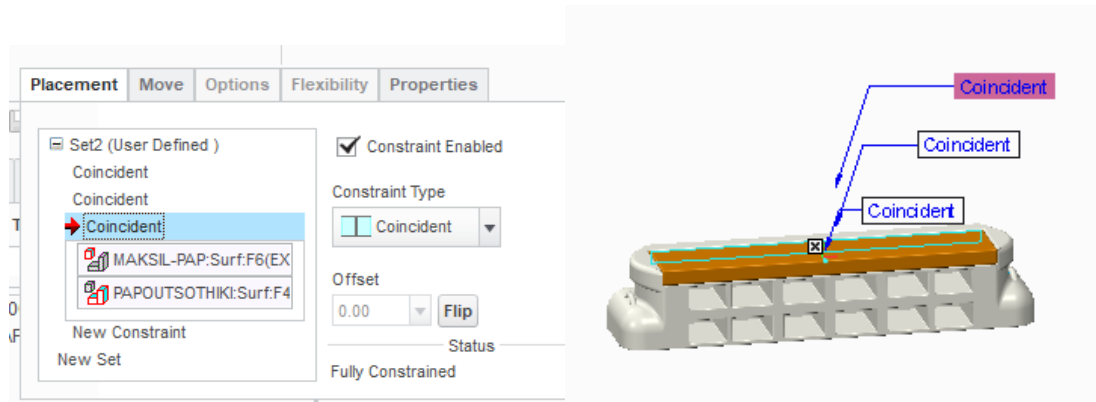
Εικόνα 5. 6 σταθερή σύνδεση coincident ,3 η αναφορά
