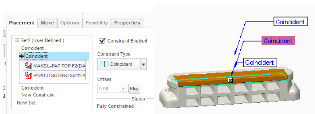
Εικόνα 5. 5 σταθερή σύνδεση coincident , 2 η αναφορά
