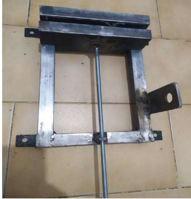
Φωτογραφία 13: Συγκόλληση λάμας με οπή \varnothing 10mm για τοποθέτηση δακτυλίου συγκράτησης
