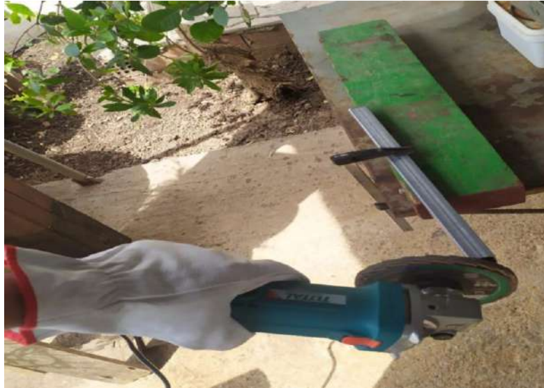
Φωτογραφία 5: Λείανση των τεμαχίων και απομάκρυνση γρεζιών
