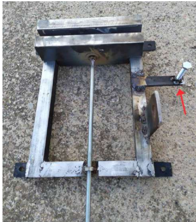
Φωτογραφία 13: Συγκόλληση λάμας με οπή \varnothing 10mm για τοποθέτηση δακτυλίου συγκράτησης
