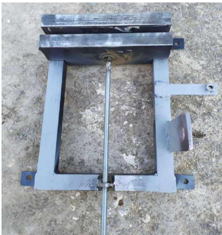
Φωτογραφία 15: Λειάνσεις και αστάρωμα για προστασία από οξείδωση
