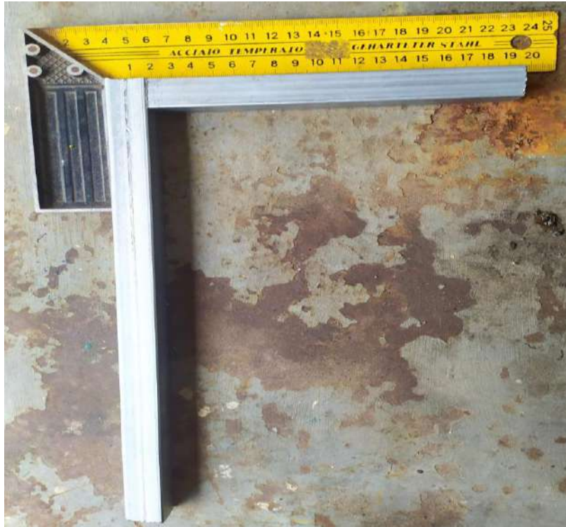
Φωτογραφία 7: Γώνιασμα τεμαχίων (τοποθέτηση σε ορθή γωνία)
