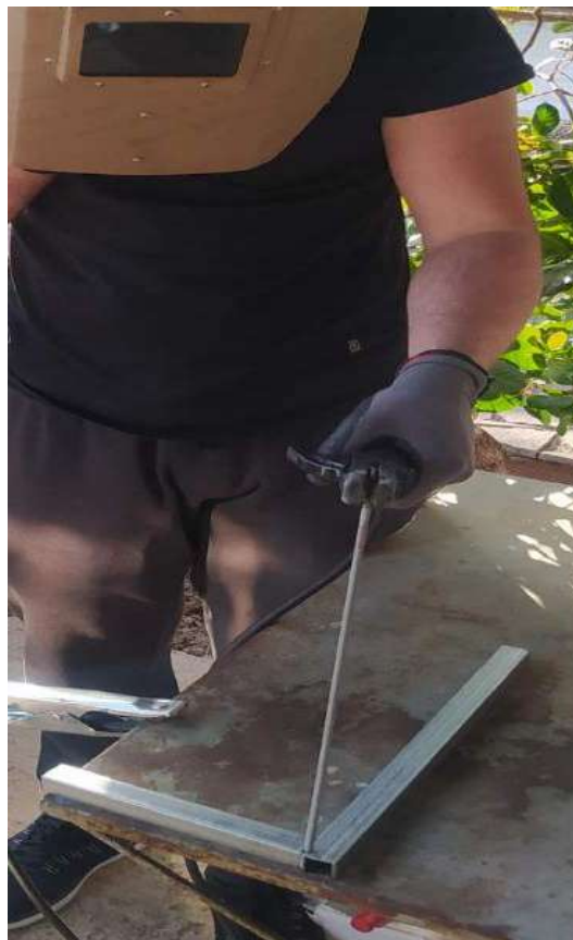
Φωτογραφία 8: Συγκόλληση τεμαχίων για την κατασκευή της βάσης της μέγγενης
