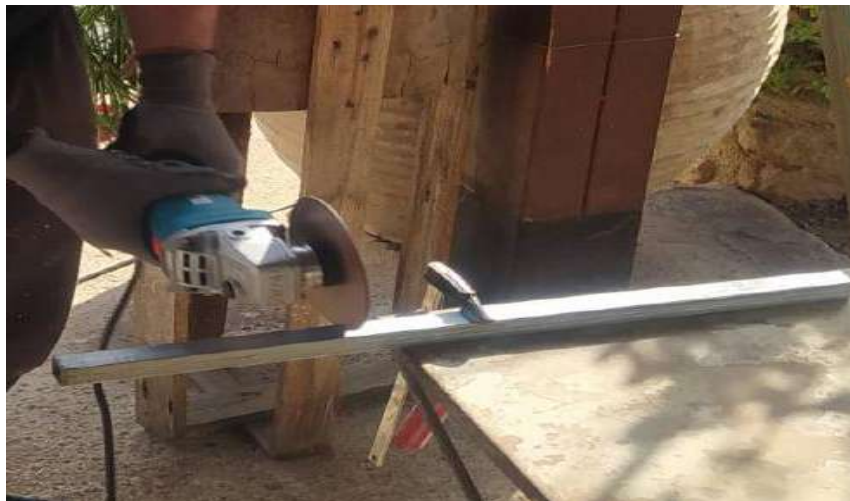
Φωτογραφία 2: Μέτρηση και κοπή των τεμαχίων
