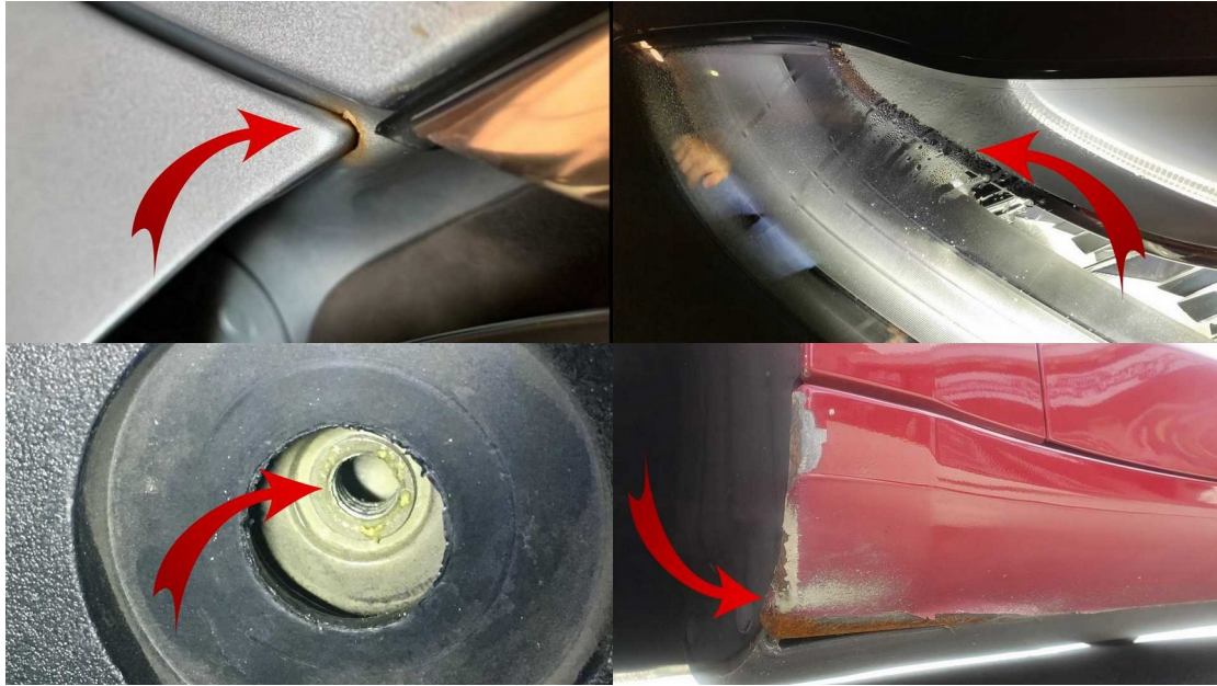
Εικόνα 5 Προβλήματα ποιότητας στο εσωτερικό και εξωτερικό του οχήματος Tesla Model 3, πηγή https://insideevs.com/features/377882/issues-tesla-model-3-guide/
