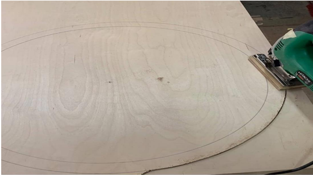
Εικόνα 22: Κοπή επιφάνειας κύκλου διαμέτρου \Phi 63 , με χρήση κοπτικού εργαλείου, για την κατασκευή του τραπεζιού.
