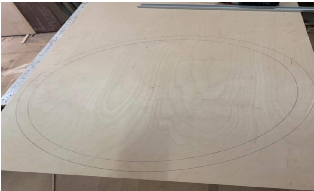
Εικόνα 21: Χάραξη επιφάνειας κύκλου \Phi 63 για προετοιμασία κοπής.
