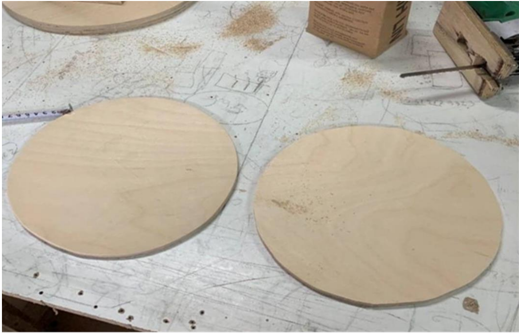
Εικόνα 24: Κομμάτια σημύδας που χρησιμοποιήθηκαν για την κατασκευή της βάσης των επιπλών.
