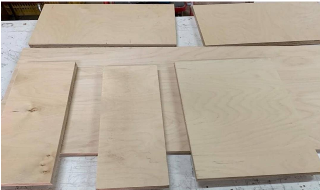
Εικόνα 23: Κομμάτια σημύδας που χρησιμοποιήθηκαν για την κατασκευή.
