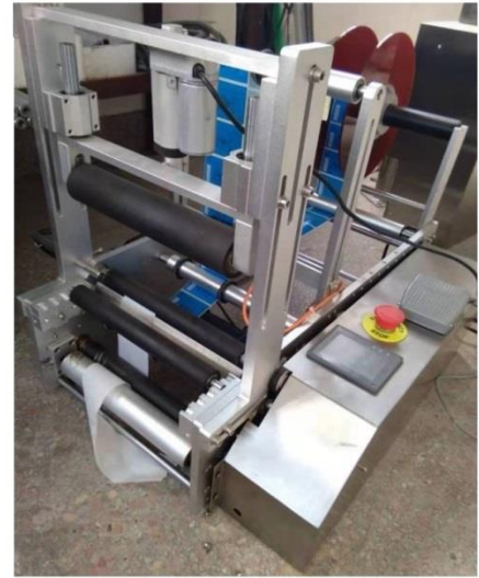
Εικόνα 1.2.1. Ημι-αυτόματο μηχανήμα μίας ή δύο ετικετών σε στρόγγυλες συσκευασίες.
