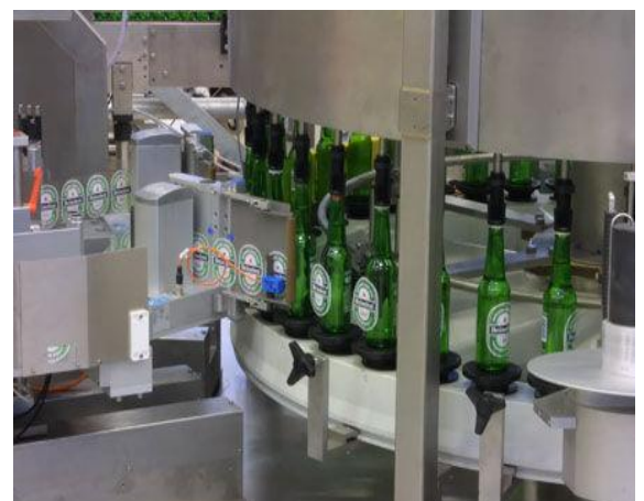
Εικόνα 1.2.4. Διαδικασία αυτόματου μηχανήματος ετικετών περιστρεφόμενης φιάλης.
