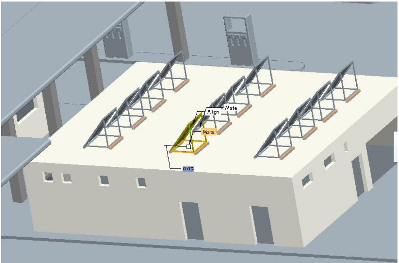
Εικόνα 116 Τελική Τοποθέτηση Ηλιακών Πάνελ
