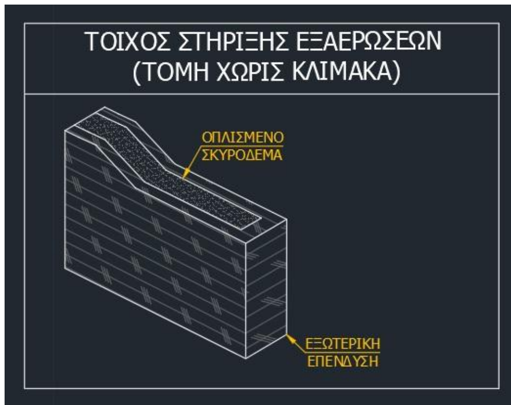
Εικόνα 4 Τοίχος Στήριξης Εξαερώσεων
