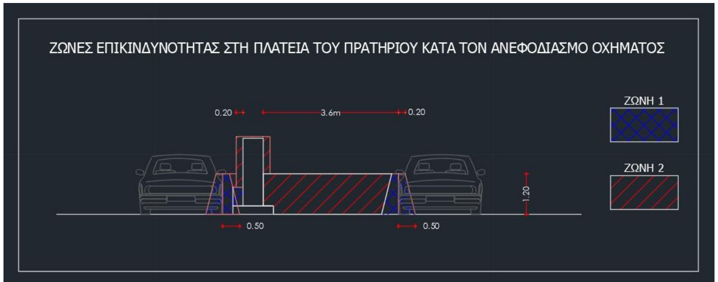
Εικόνα 39 Ζώνη Ατεχστη Πλατεία Πρατηρίου κατά τον Ανεφοδιασμό
