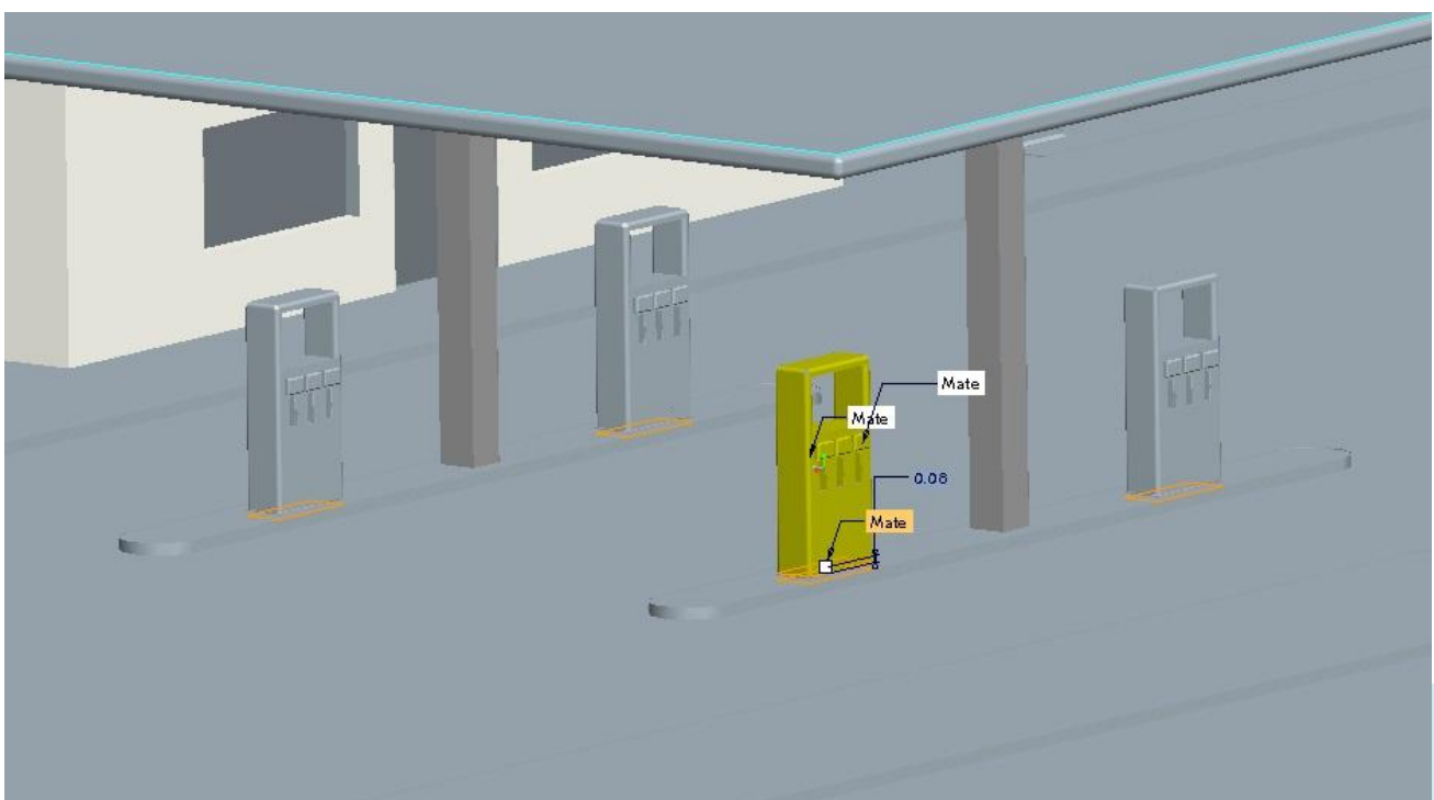
Εικόνα 111 Τοποθέτηση Αντλιών στις Νησίδες
