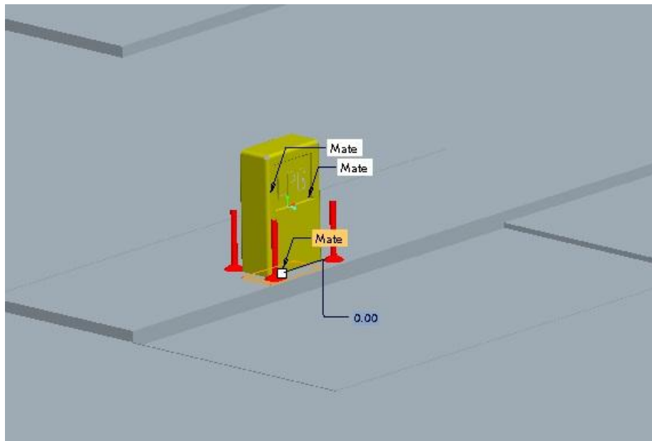
Εικόνα 114 Τοποθέτηση Αντλίας Lpg
