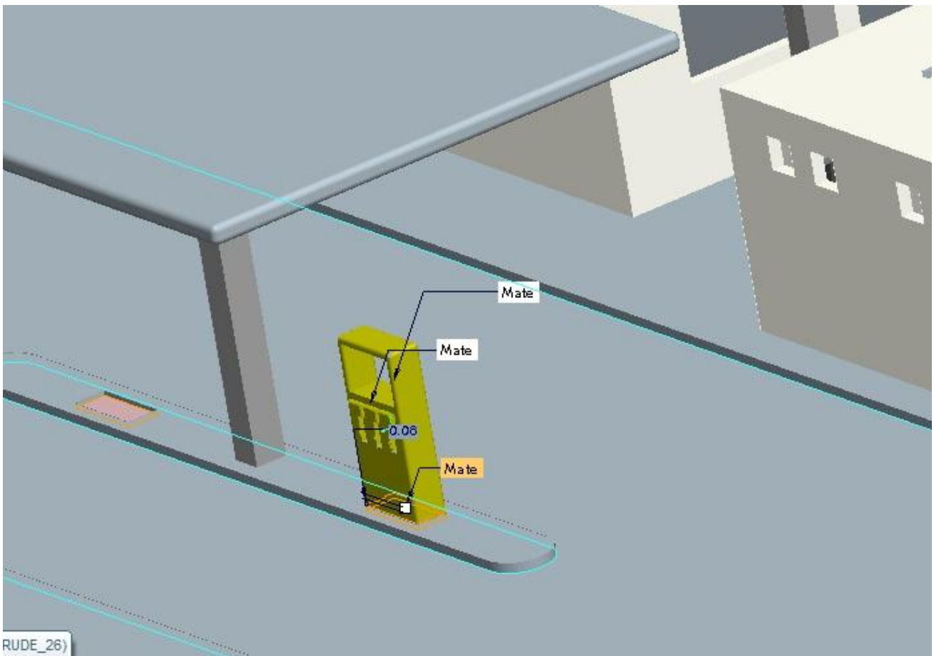
Εικόνα 110 Τοποθέτηση Αντλίας Καυσίμων
