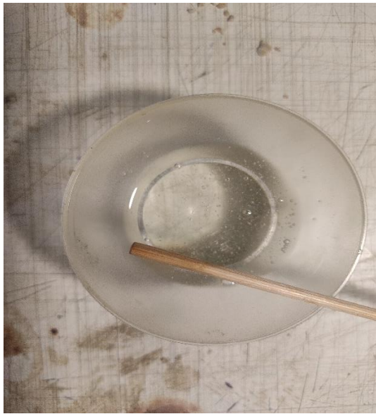
Εικόνα 41 : Μίγμα εποξικής ρητίνης
