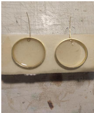
Εικόνα 42: Τοποθέτηση εποξικής ρητίνης
