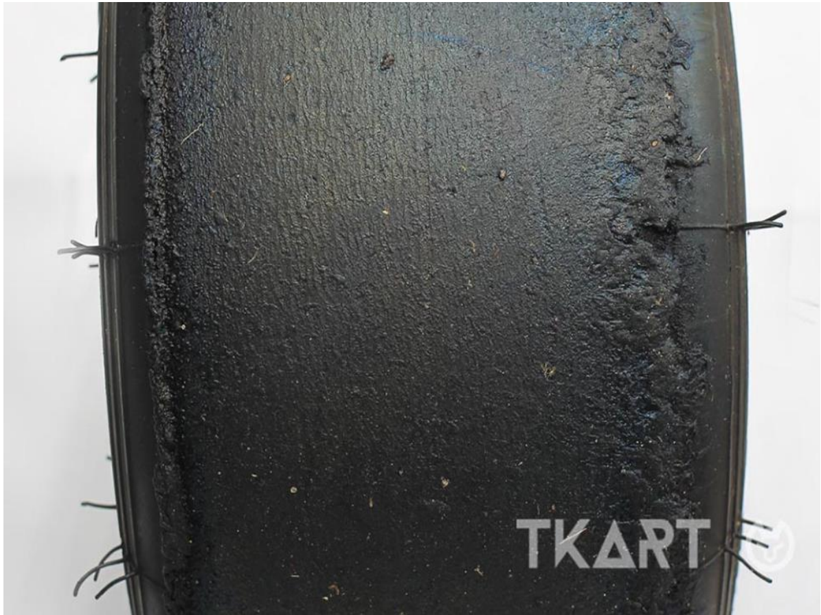
Εικόνα 2.14 : Παράδειγμα ελαστικού υπό συνθήκες ρύθμισης υπερβολικού camber ( https://tkart.it )
