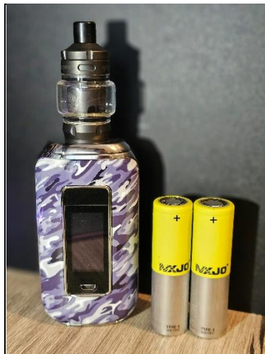
Εικόνα 6. Mod με δύο μπαταρίες 18650
