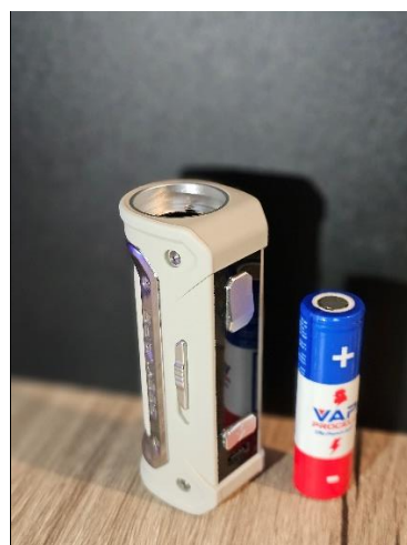
Εικόνα 4. Mod με μια μπαταρία 18650 με μαγνητικό πόλο
