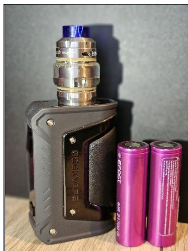
Εικόνα 7. Mod με δύο μπαταρίες 21700
