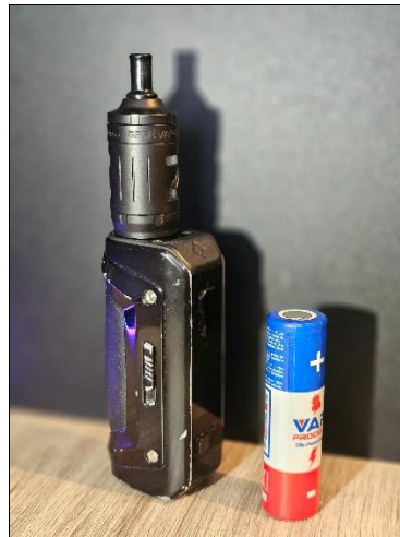
Εικόνα 3. Mod με μια μπαταρία 18650 με σπείρωμα
