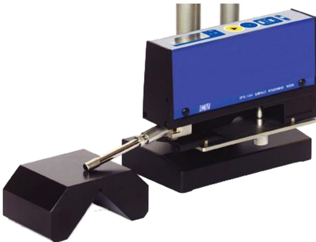
Εικόνα 4.7. Το τραχύμετρο που χρησιμοποιήσαμε πάνω σε ειδική βάση στήριξης.
