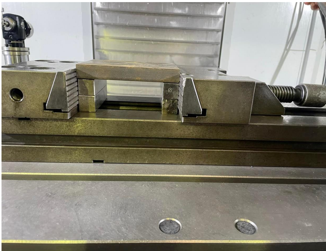
Εικόνα 30. Στήσιμο εργαλειογάλβα ck60
