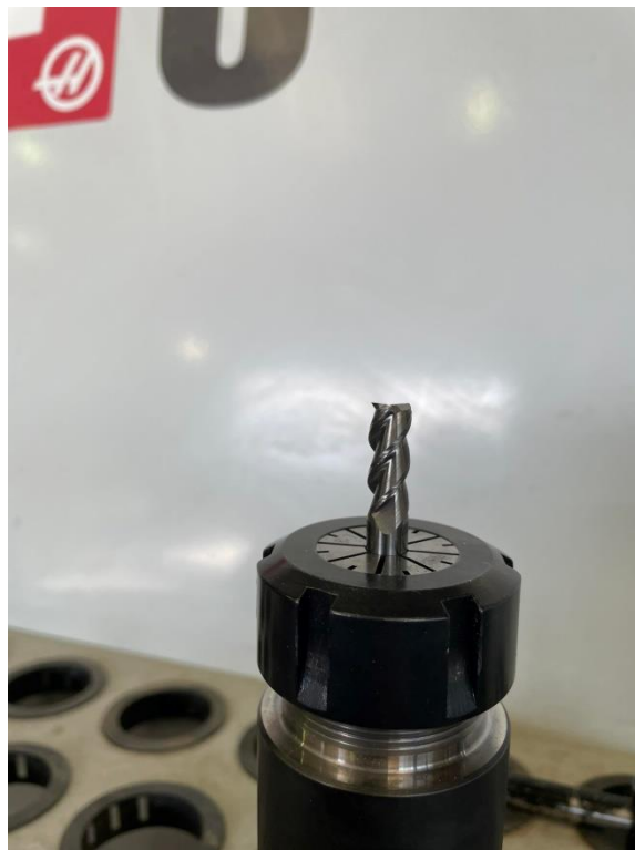
Εικόνα 37. Σετάρισμα κονδυλιού αλουμινίου 8mm
