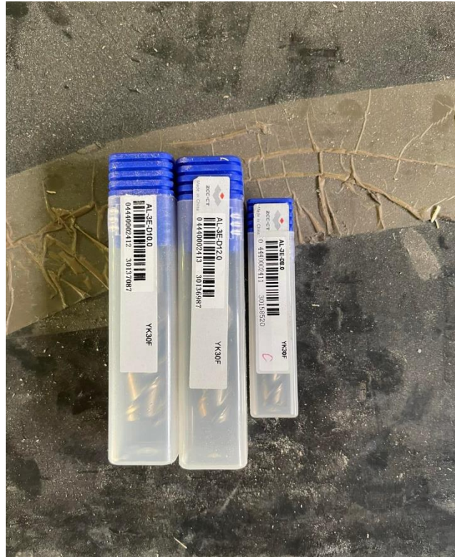
Εικόνα 8. Τριάδα κονδυλιών 3z καρβιδίου για αλουμίνιο, διαμέτρων οκτώ,δέκα και δώδεκα χιλιοστών
