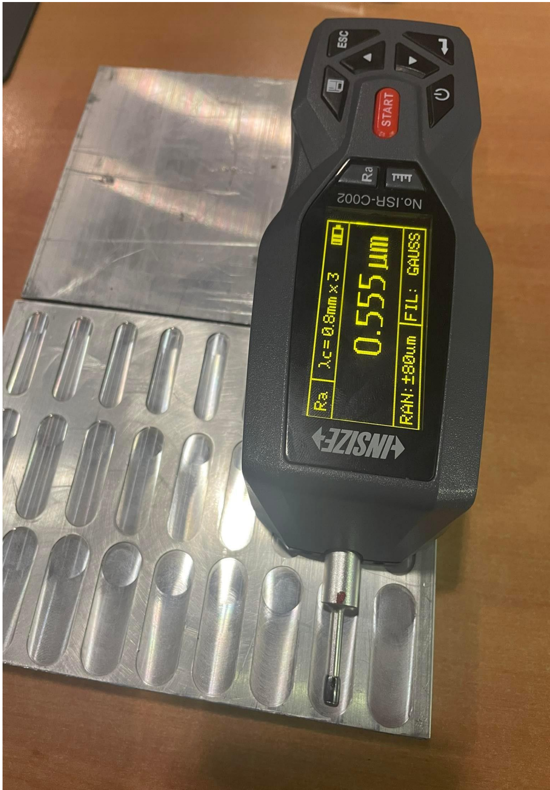
Εικόνα 46. Τραχύμετρο κατά την διάρκεια μέτρησης στο κομμάτι αλουμινίου 7075 μετά την κατεργασία
