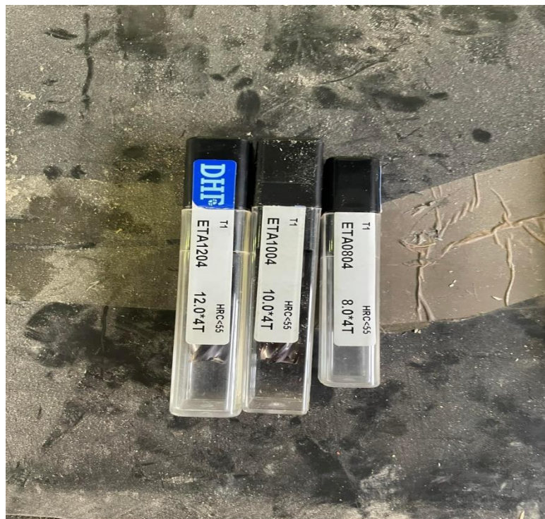
Εικόνα 9. Τριάδα κονδυλιών 4z καρβιδίου, διαμέτρων οκτώ,δέκα και δώδεκα χιλιοστών
