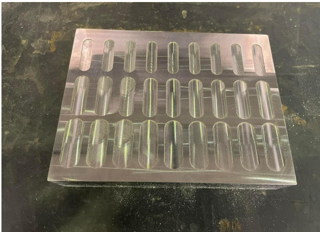
Εικόνα 58. Τελικό κομμάτι, ανοξείδωτος χάλυβας GX4CrNi13-4
