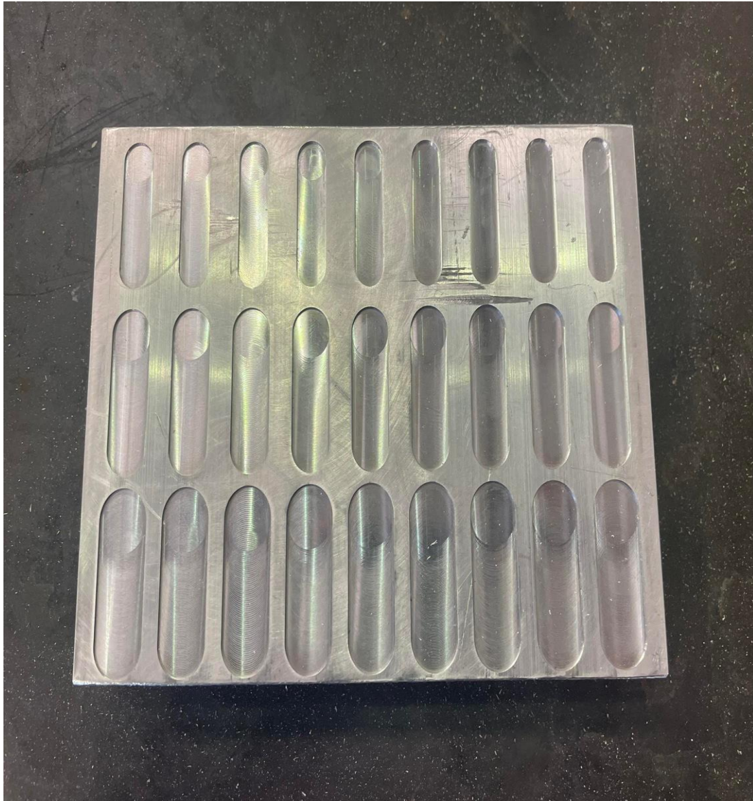
Εικόνα 56. Τελικό κομμάτι, αλουμίνιο 7075
