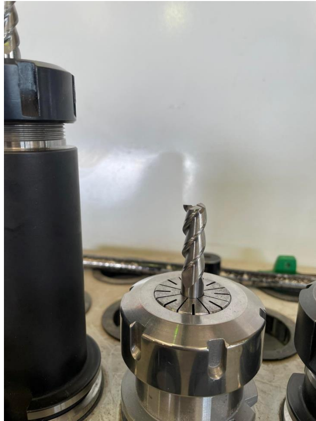
Εικόνα 38. Σετάρισμα κονδυλιού αλουμινίου 10mm
