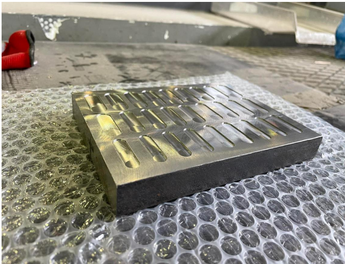
Εικόνα 57. Τελικό κομμάτι, εργαλειοχάλυβας ck60
