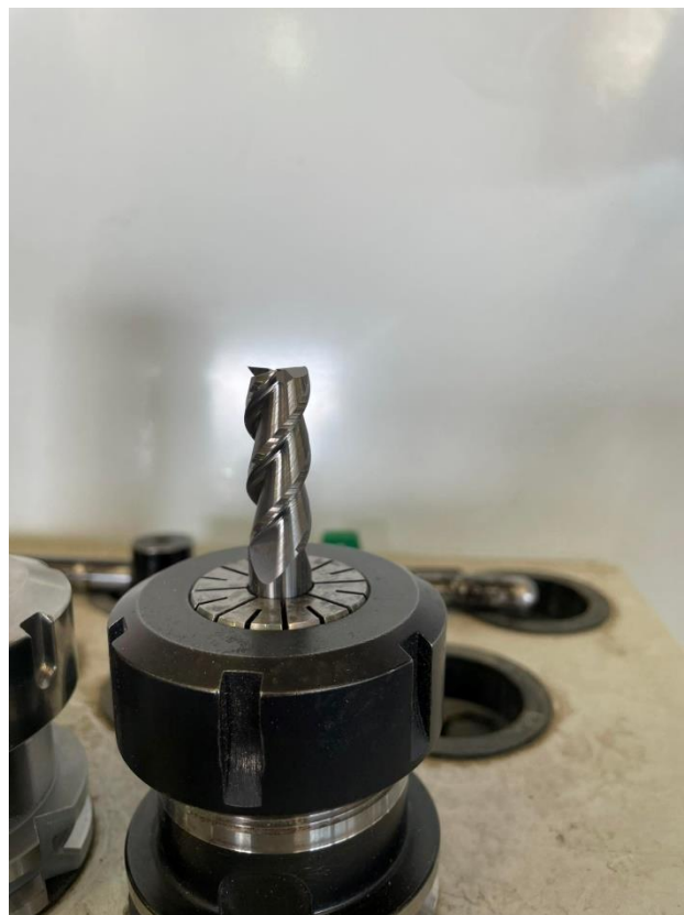
Εικόνα 39. Σετάρισμα κονδυλιού αλουμινίου 12mm
