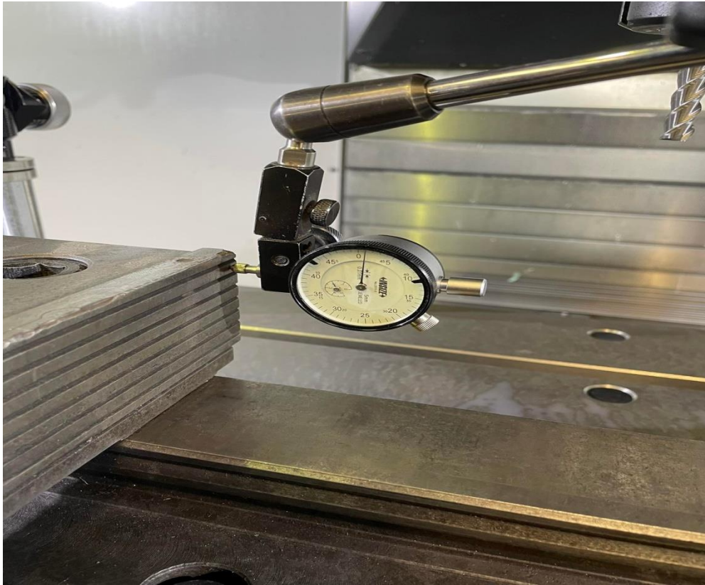
Εικόνα 24. Μηδενισμός της μέγγενης με την βοήθεια του ρολογίου
