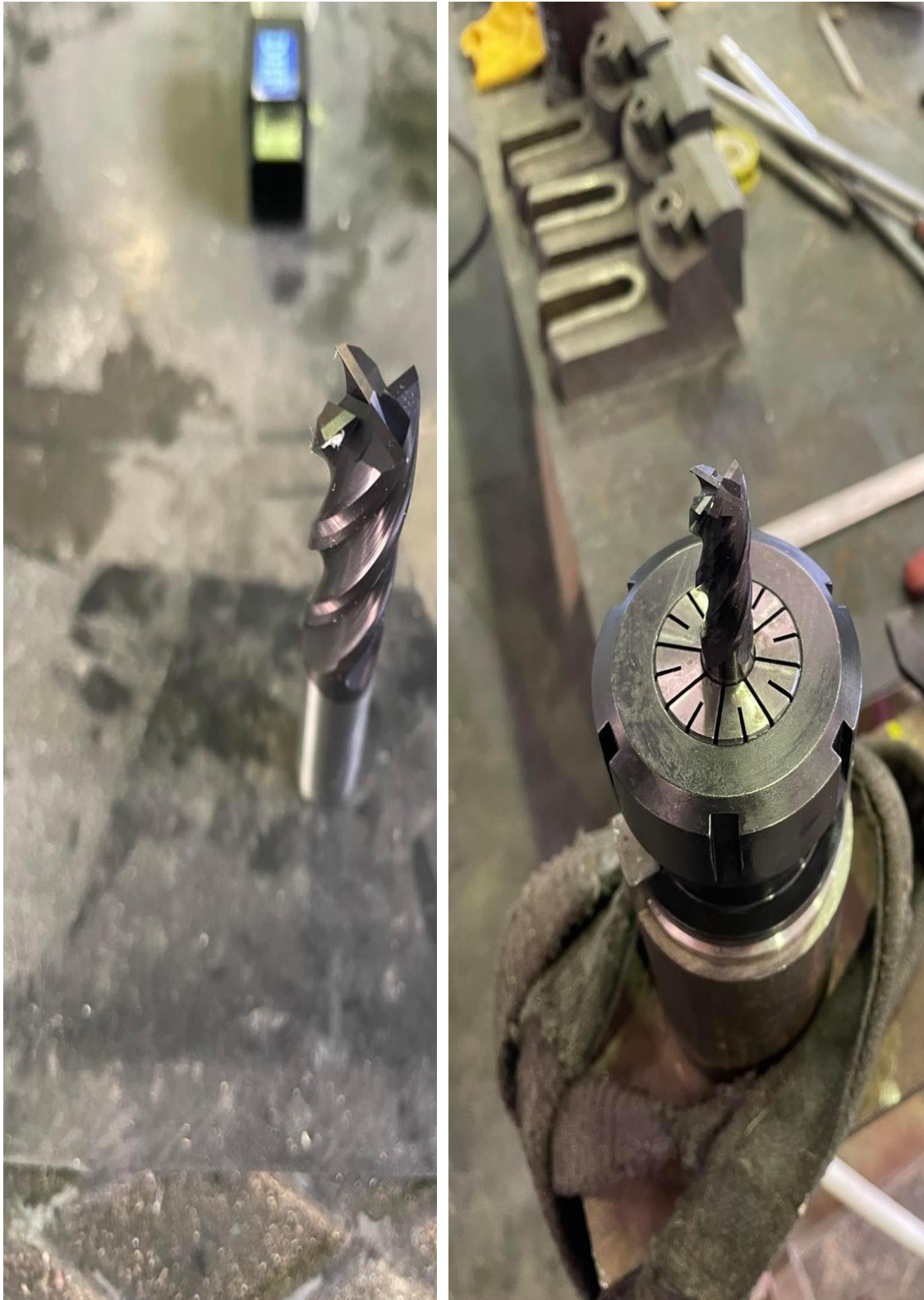
Εικόνα 52. Εικόνα όπου: α) κονδύλι καρβιδίου 12mm πριν την κατεργασία στον ck60 β) κονδύλι καρβιδίου 12mm μετά την κατεργασία στον ck60
