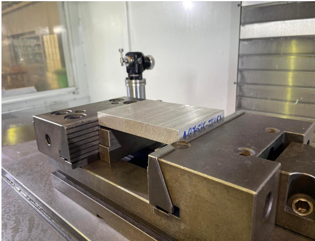
Εικόνα 28. Στήσιμο αλουμινίου 7075 απο άλλη γωνία
