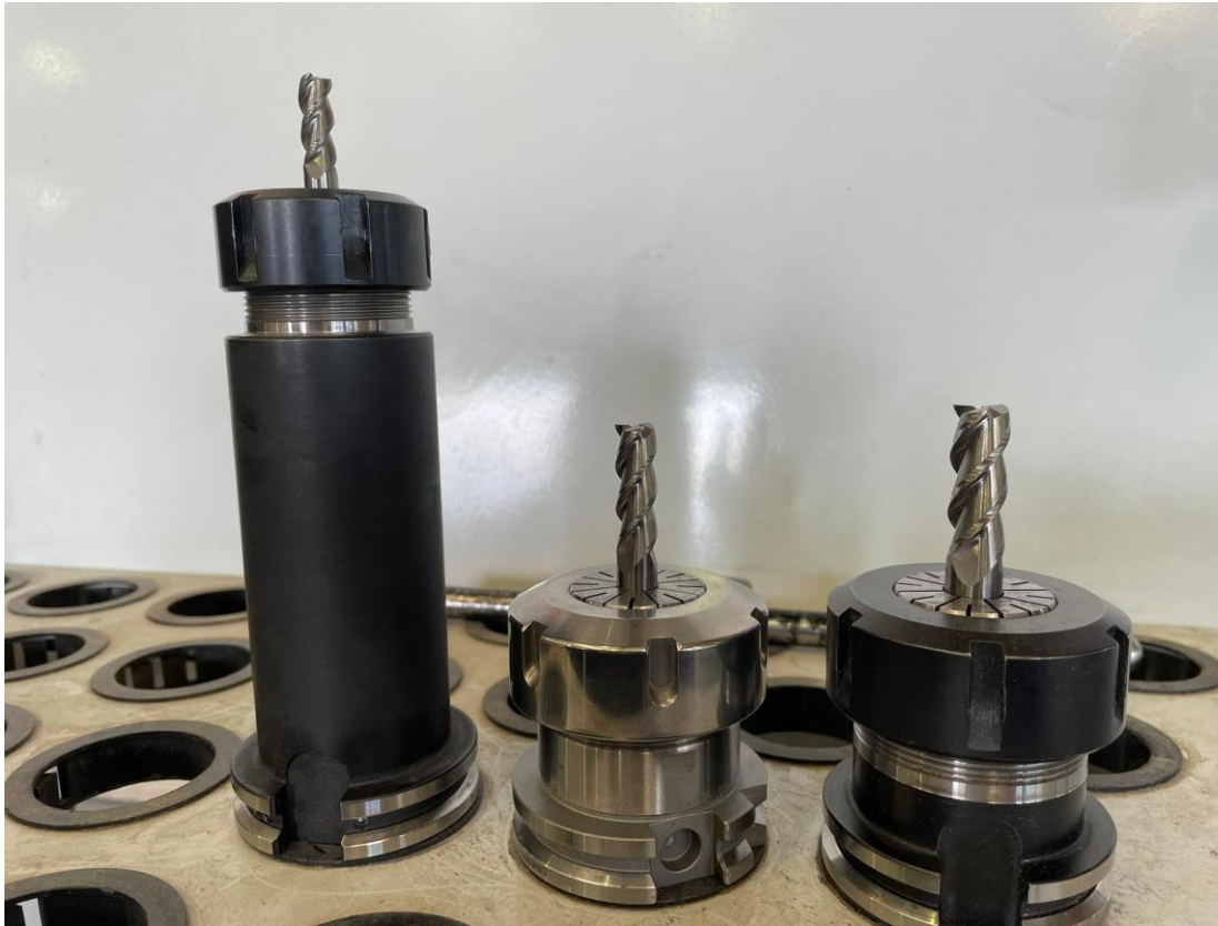
Εικόνα 36. Σετάρισμα των κονδυλιών αλουμινίου
