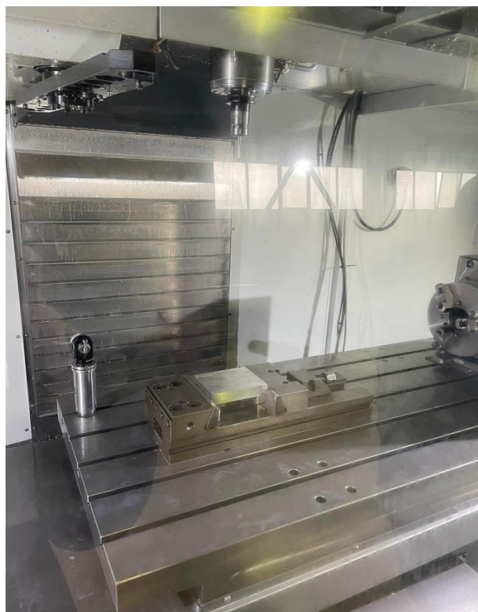
Εικόνα 35. Touch probe μετά τον μηδενισμό του ανοξείδωτου χάλυβα GX4CrNi13-4
