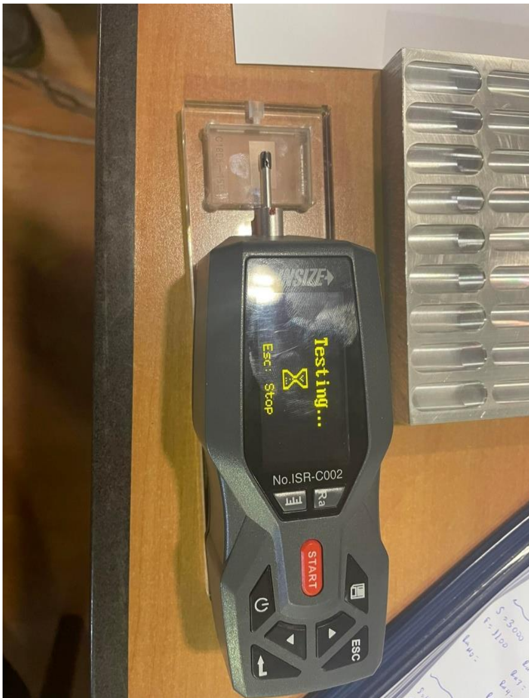
Εικόνα 45. Ένδειξη του τραχυμέτρου όταν μετράει
