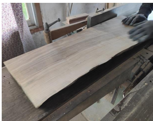
Εικόνα 58. Κατεργασία δεύτερης πλευράς ξύλου
