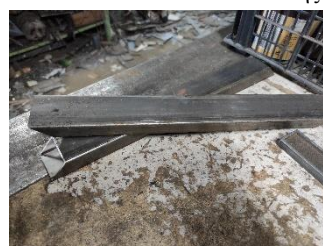
Εικόνα 195. Κοπή βάσης ποδιών με γωνία 45 μοιρών και στις δύο άκρες
