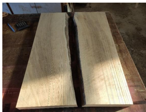
Εικόνα 62. Τελικό αποτέλεσμα μετά από κοπή με χρήση γωνιάστρας και κατεργασία πλάνης
