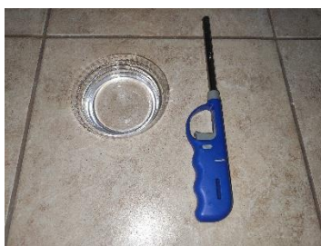
Εικόνα 113. Αφαίρεση φυσαλίδων με αναπτήρα
