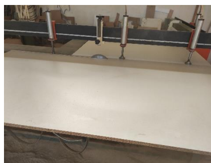
Εικόνα 68. Κοπή της βάσης του καλουπιού
