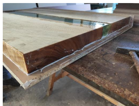
Εικόνα 127. Αφαίρεση δύο πλευρών του καλουπιού
