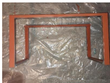
Εικόνα 215. Εφαρμογή ασταριού στις πλαϊνές επιφάνειες
