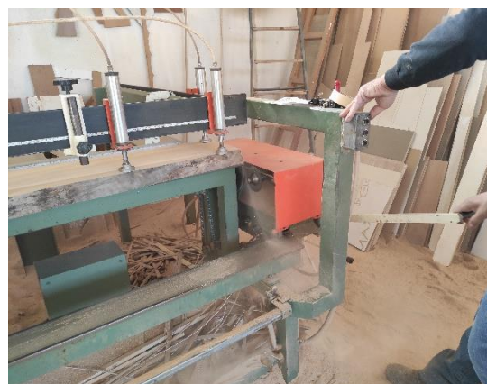
Εικόνα 55. Κοπή ξύλου σε κάθετο άξονα
