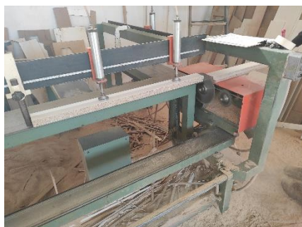
Εικόνα 69. Κοπή πλαϊνών πλευρών καλουπιού
