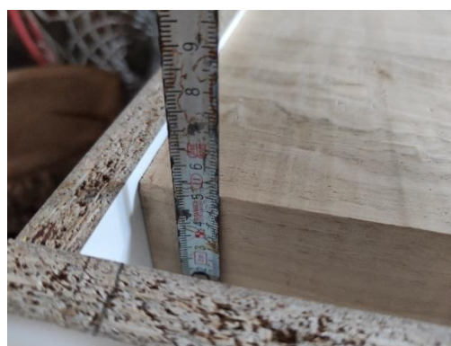
Εικόνα 64. Μετά την κατεργασία των ξύλων στην πλάνη παρατηρείται πως το πάχος είναι 5,2 εκατοστά
