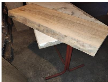
Εικόνα 89. Αποτέλεσμα εσωτερικής πλευράς μετά από κατεργασία με τραχύ σφουγγάρι λείανσης
