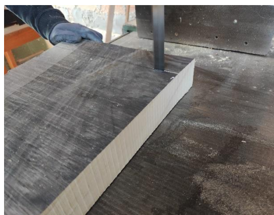
Εικόνα 53. Κοπή μήκους στην επιθυμητή διάσταση
