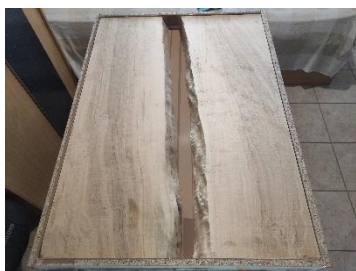
Εικόνα 96. Τοποθέτηση ξύλων μέσα στο καλούπι
