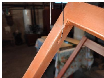
Εικόνα 217. Διαπέραση σύρματος από οπή βάσης
