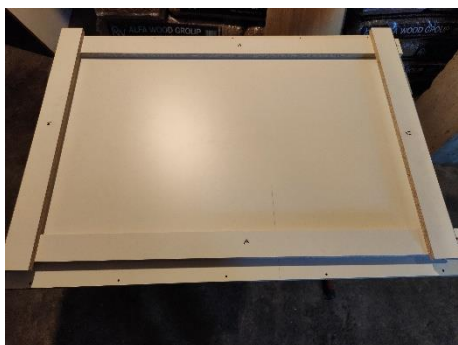
Εικόνα 76. Αποσυναρμολόγηση του καλουπιού
