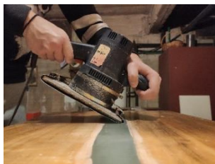
Εικόνα 160. Λείανση με γωνία 45 μοιρών
