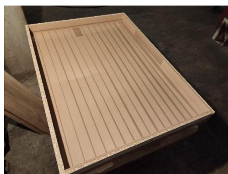
Εικόνα 81. Τελικό αποτέλεσμα καλουπιού μετά από την συναρμολόγηση
