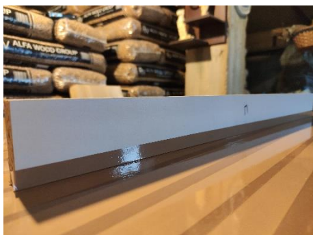
Εικόνα 78. Εφαρμογή κολλητικής ταινίας στο κάτω μέρος της πλαϊνής πλευράς
