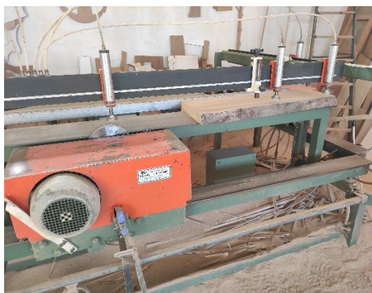
Εικόνα 54. Κοπή ξύλου σε οριζόντιο άξονα
