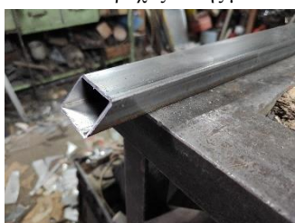
Εικόνα 194. Κοπή ύψους με γωνία 45 μοιρών στη μία άκρη
