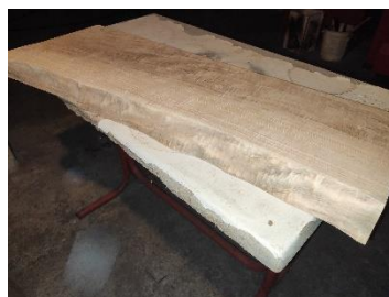
Εικόνα 93. Τελικό αποτέλεσμα μετά από κατεργασία με χρήση λείου σφουγγαριού λείανσης
