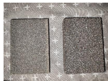
Εικόνα 33. Σφουγγάρια λείανσης λείας επιφάνειας στα αριστερά και τραχιάς επιφάνειας στα δεξιά
