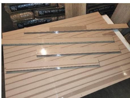
Εικόνα 80. Ολοκλήρωση εφαρμογής της κολλητικής ταινίας σε όλα τα κομμάτια του καλουπιού
