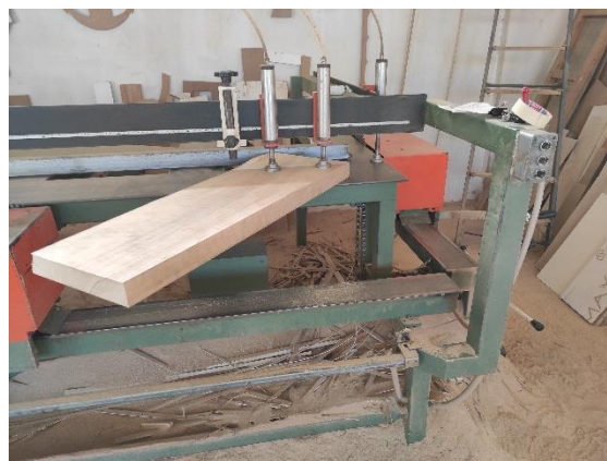
Εικόνα 56. Στην εικόνα παρουσιάζεται ο τρόπος σταθεροποίησης του ξύλου με την χρήση των ποδιών όπου λειτουργούν με πίεση αέρα
