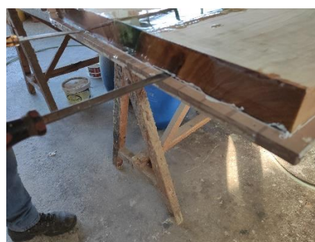
Εικόνα 129. Κάθετη πίεση κατσαβιδιών για την αφαίρεση του τραπεζιού
