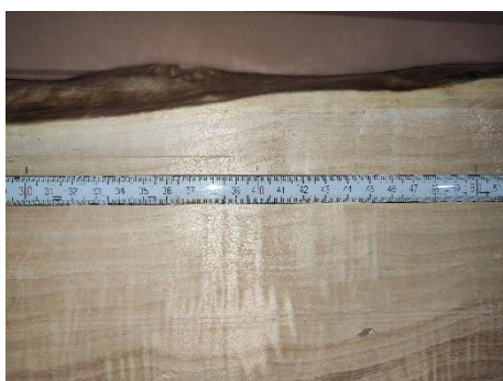
Εικόνα 102. Μέτρηση πλάτους ανά 10cm
