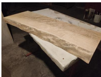
Εικόνα 92. Αποτέλεσμα εσωτερικής πλευράς μετά από κατεργασία με τραχύ σφουγγάρι λείανσης
