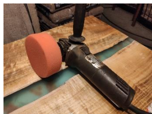
Εικόνα 163. Εφαρμογή σφουγγαριού σε τροχό
