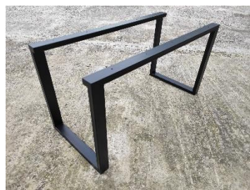
Εικόνα 219. Τελικό αποτέλεσμα βάσης μετά από βαφή
