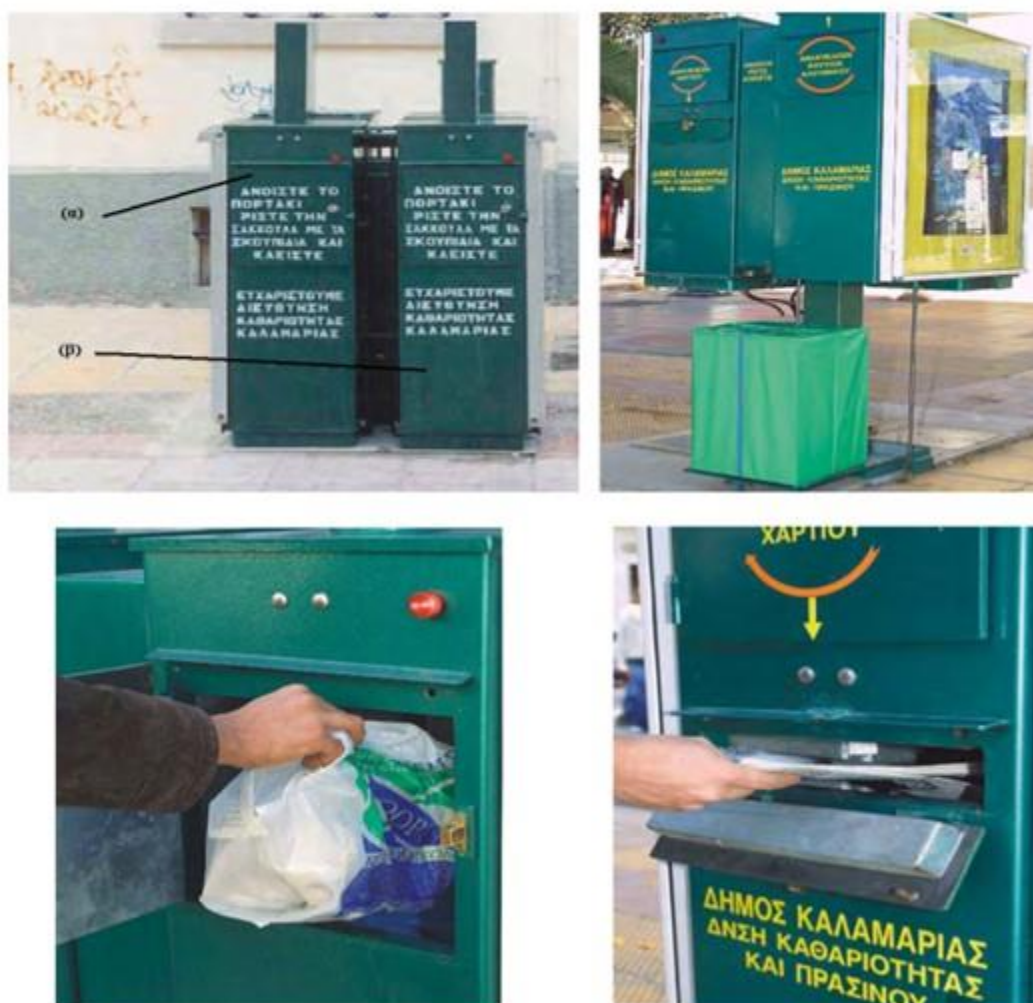
Εικόνα Α5.Σύστημα προσωρινής αποθήκευσης με ενσωματωμένο θάλαμο συμπίεσης.
