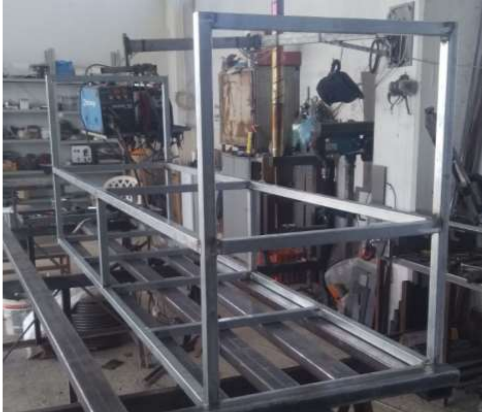
ΕΙΚΟΝΑ 10. Κατασκευή δεύτερου πλαισίου.
