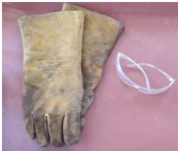
ΕΙΚΟΝΑ 1. Γάντια ηλεκτροσυγκολλητή και προστατευτικό γυαλί εργασίας.
