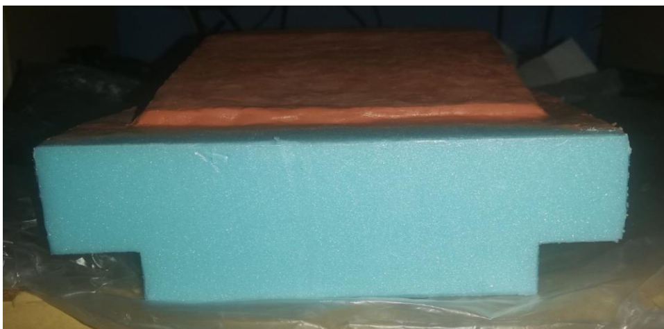
Εικόνα 9.47 το πίσω μέρος του αυτοκινήτου πριν αφαίρεση φελιζολ για την δημιουργία των πίσω προβολών του αυτοκινήτου
