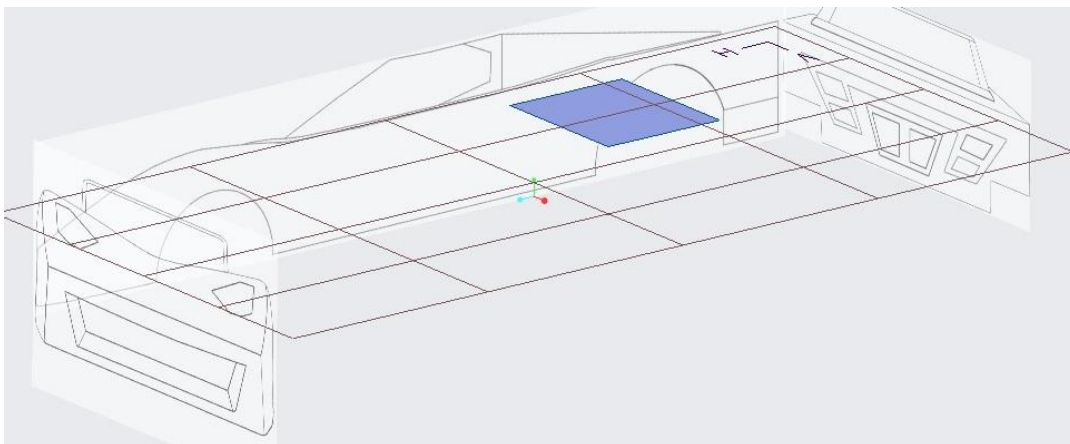
Εικόνα 9.24 την κατασκευή του ουρανού του αυτοκινήτου
