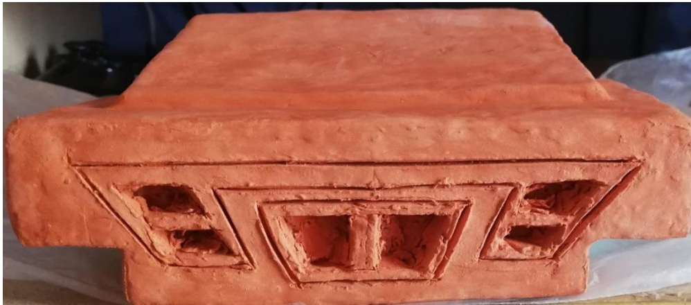
Εικόνα 9.49 γέμισμα του κενού με πηλό και την δημιουργία των πίσω προβολών
