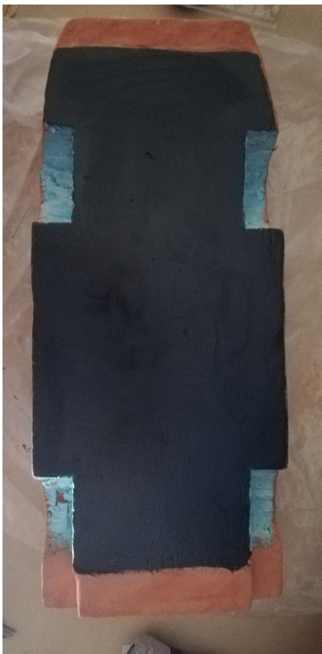
Εικόνα 9.58 το βάψιμο της κάτω επιφάνειας (πάτωμα) του αυτοκινήτου με μαύρο χρώμα
