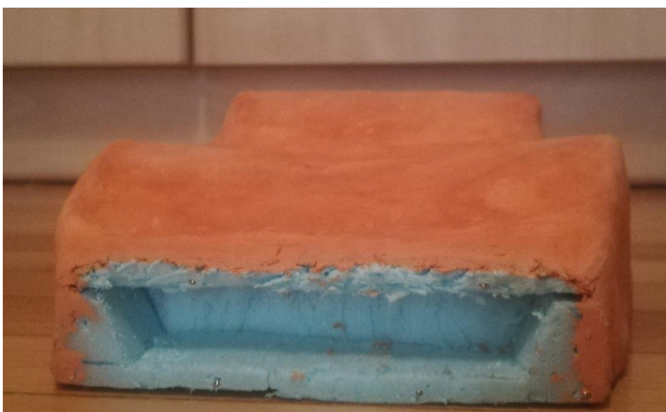
Εικόνα 9.46 επικάλυψη και της εμπρός όψης αυτοκινήτου με πηλό
