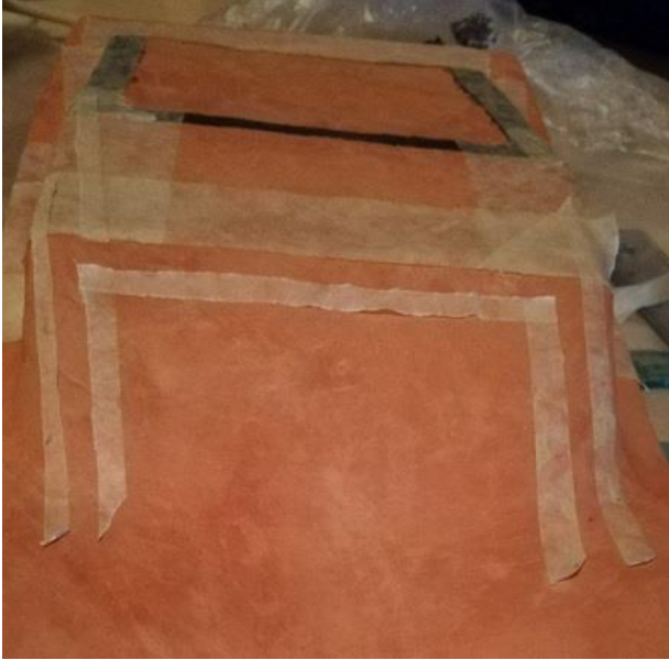
Εικόνα 9.62 σχεδιασμός με ταινία το μπροστινό παρμπρίζ του αυτοκινήτου και έπειτα βάψιμο του
