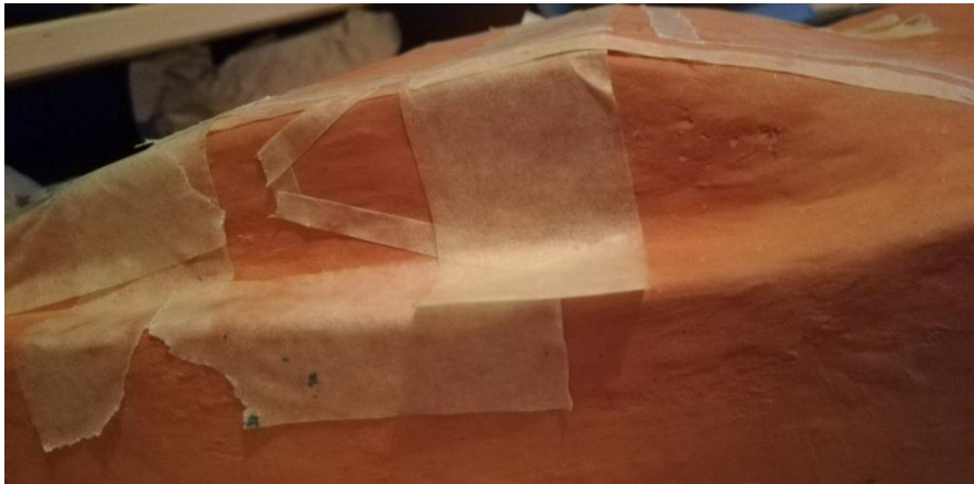
Εικόνα 9.60 καθορισμός-σχεδιασμός της περιοχής του αυτοκινήτου που θα βαφτεί με μαύρο χρώμα και θα ενώνει το αμάξωμα με το τζάμι του παραθύρου
