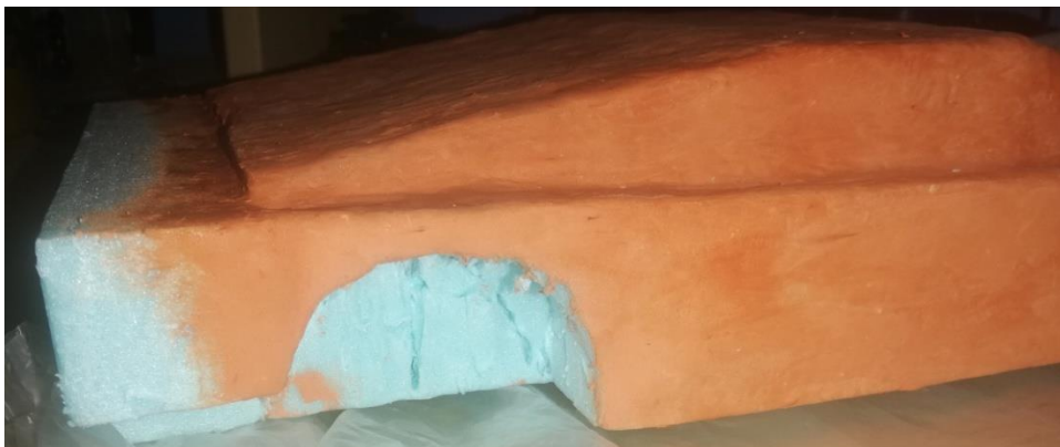
Εικόνα 9.45 συνέχιση της επικάλυψης του φελιζολ από πηλό
