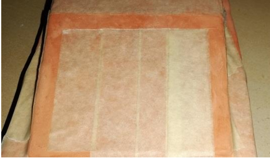
Εικόνα 9.59 καθορισμός με ταινία τα μέρη που δεν πρέπει να βαφτούν την συγκεκριμένη στιγμή
