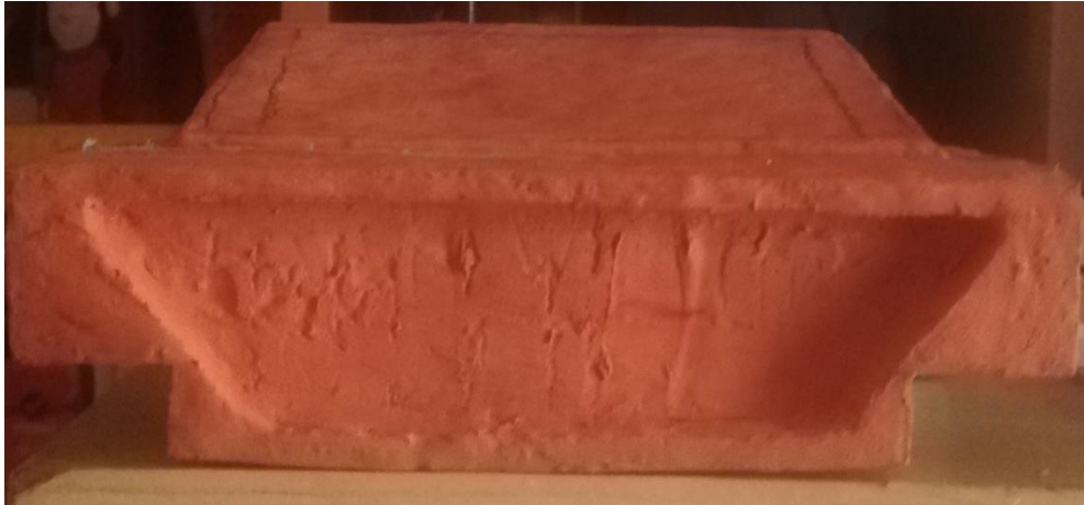
Εικόνα 9.48 μετά την αφαίρεση του φελιζολ και την επικάλυψη με πηλό
