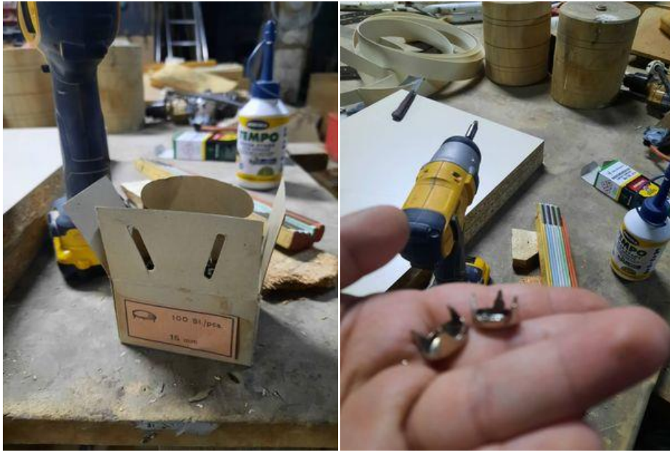
Εικόνα 24. Τοποθέτηση ποδιών για καλύτερη σταθερότητα
