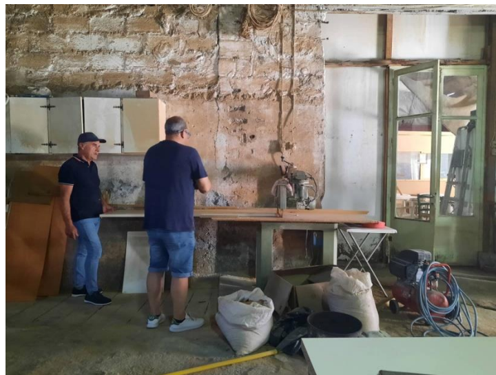
Εικόνα 18. Τροχός για την Κοπή του Ξύλου από 183mm σε 178mm
