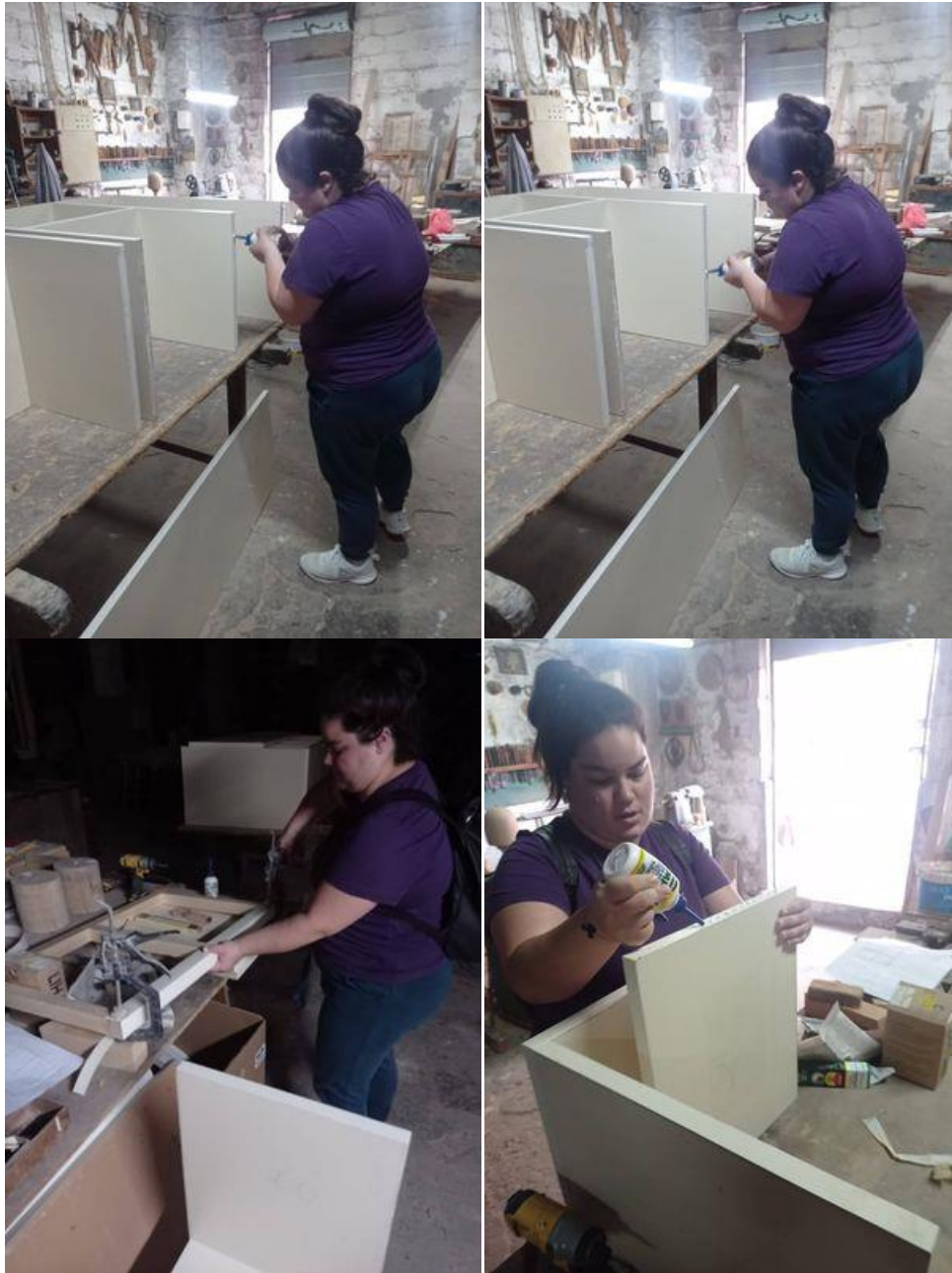
Εικόνα 21. Τοποθέτηση Κόλλας για καλύτερη αντοχή στη διάρκεια ζωής του
