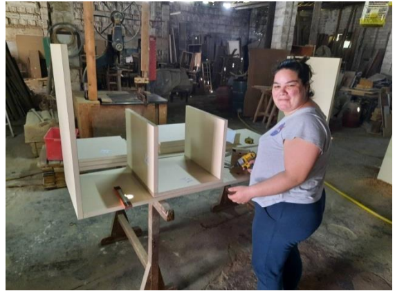
Εικόνα 19. Βίδωμα Γωνιών για Κεντρικό έπιπλο και σκαμπό
