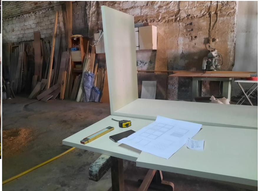
Εικόνα 19. Βίδωμα Γωνιών για Κεντρικό έπιπλο και σκαμπό
