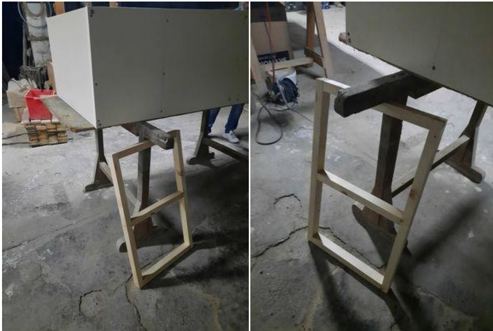
Εικόνα 23. Δημιουργία βάσης σε σχήμα θήτα για καλύτερη σταθερότητα
