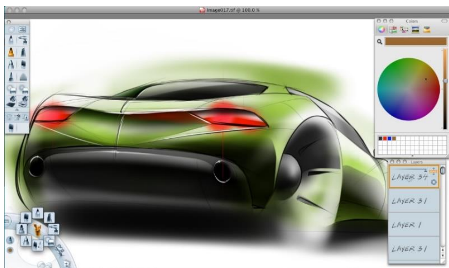
Εικόνα 15 : Σχεδίαση πίσω μέρους αυτοκινήτου υψηλών προδιαγραφών με χρήση του Autodesk Sketch-Book. ΠΗΓΗ : Συγγραφείς της DifferenceBetween.net, Difference Between Procreate and Sketchbook, DifferenceBetween.net, 2022.
