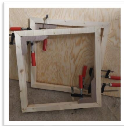
Εικόνα 38 : Σύνδεση των διαφόρων τμημάτων των δοκών μεταξύ τους με ξυλόβιδες και ειδική κόλλα ξύλου και τοποθέτηση γωνιάστρων για την ορθή επικόλληση.
