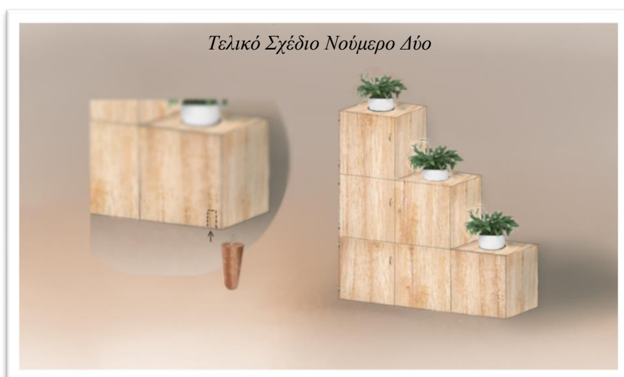
Εικόνα 31 : Έξι συνολικά κύβοι με διαφορετική τοποθέτηση ο ένας επάνω και δίπλα στον άλλον για την δημιουργία καθίσματος και βιβλιοθήκης με κατάλληλες μεταλλικές θήρες και ποδαρικό.
