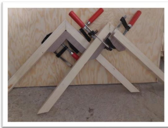
Εικόνα 38 : Σύνδεση των διαφόρων τμημάτων των δοκών μεταξύ τους με ξυλόβιδες και ειδική κόλλα ξύλου και τοποθέτηση γωνιάστρων για την ορθή επικόλληση.
