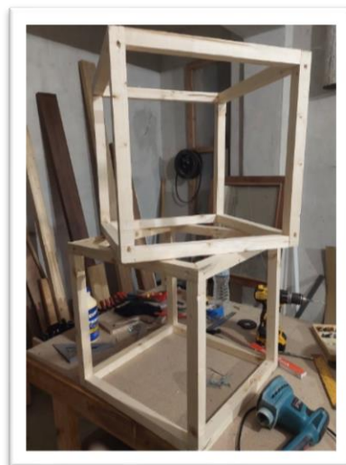
Εικόνα 39 : Σύνδεση των διαφόρων τμημάτων για την δημιουργία του σκελετού του κύβου.
