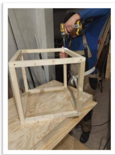
Εικόνα 39 : Σύνδεση των διαφόρων τμημάτων για την δημιουργία του σκελετού του κύβου.
