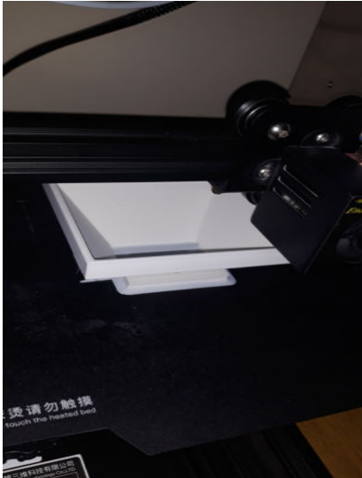
Εικόνα 72 : Φωτογραφίες κατά τη διάρκεια της παραγωγής του δοχείου τροφοδοσίας.Χρησιμοποιήθηκε πλαστικό υλικό PLA για όλες τις εκτυπώσεις των εξαρτημάτων.
