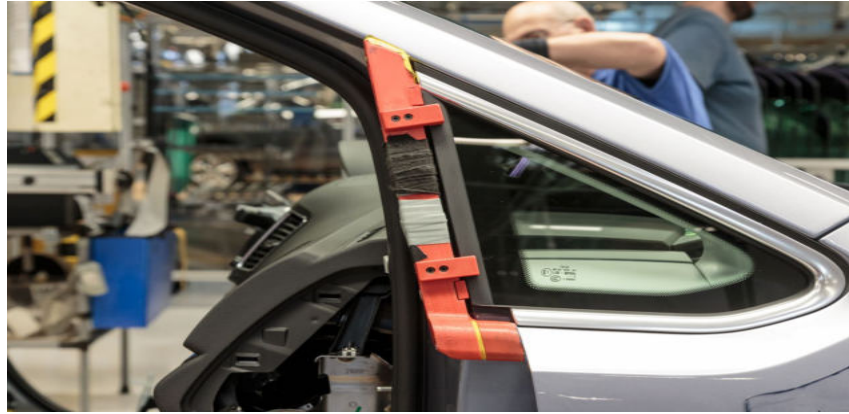
Εικόνα 18 : Αυτός ο μετρητής παραθύρου κόστιζε 180 €.Με την τρισδιάστατη εκτύπωση το κόστος 35€.Ο χρόνος ανάπτυξης μειώθηκε από 8 σε 6 ημέρες.
