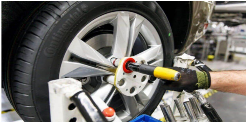
Εικόνα 19 : Αυτή η τρισδιάστατη εκτυπωμένη προστασία τροχών είχε προμήθεια 800 €. Με την τρισδιάστατη εκτύπωση το κόστος 21 €.Ο χρόνος ανάπτυξης μειώθηκε από 56 σε 10 ημέρες.
