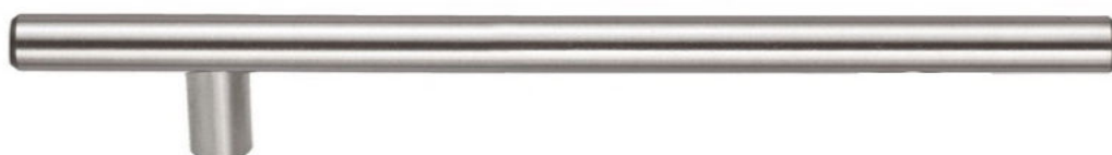
Εικόνα 46 : Πύρος αποθήκευσης υλικού κατασκευασμένος από ζάμακ. (κράμα μετάλλου με ψευδάργυρο, αλουμίνιο, μαγνήσιο και χαλκό). Με διάμετρο D = 12 mm και μήκος l = 210 mm.
