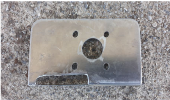
Εικόνα 67 : Κατασκευή βάσης στήριξης του κύριου ηλεκτροκινητήρα σε διαστάσεις,μήκος 130 mm και ύψος 75 mm.
