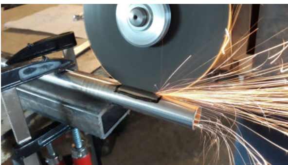
Εικόνα 68 : Κοπή σωλήνας για την τροφοδοσία του πλαστικού υλικού. Διαστάσεις αυλακιού 40 * 10 mm.Κόλληση δύο στηριγμάτων για το δοχείο τροφοδοσίας.
