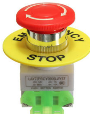
Εικόνα 58 : Διακόπτης πίεσης έκτακτης ανάγκης εναλλασσόμενου ρεύματος (AC) 600V 10A – 300V 5A – 125V 3A.
