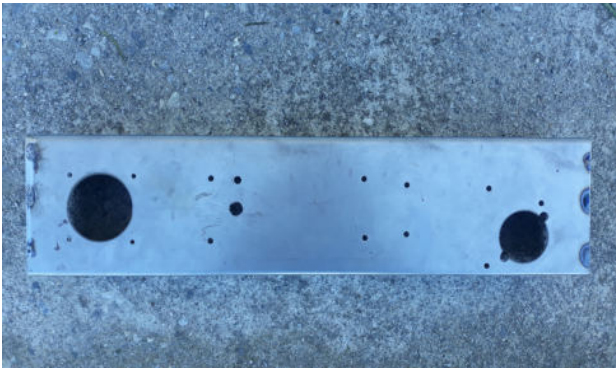
Εικόνα 65 : Ολοκλήρωση με το άνοιγμα όλων των οπών.Μήκος του μηχανήματος 650 mm,πλάτος 150 mm και ύψος 100 mm.
