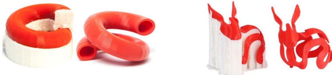
Εικόνα 5: Εκτυπωμένα αντικείμενα πριν και μετά την αφαίρεση των supports.
