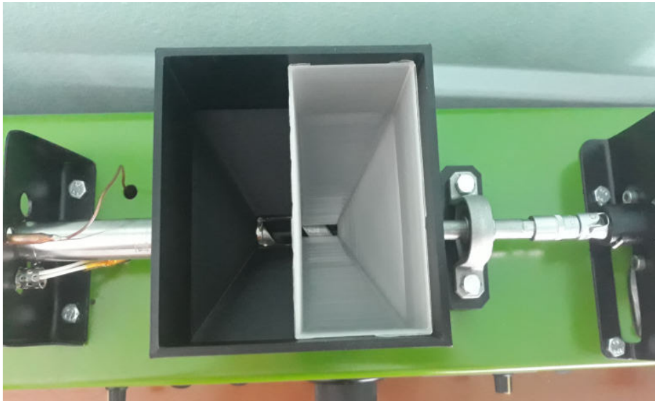
Εικόνα 83 : Τοποθέτηση μηχανικών εξαρτημάτων σπαστού σταυρού,αρίδα μεταφοράς,ρουλεμάν στήριξης,βάσεων στήριξης,εξωτερικό και εσωτερικό δοχείο στήριξης.
