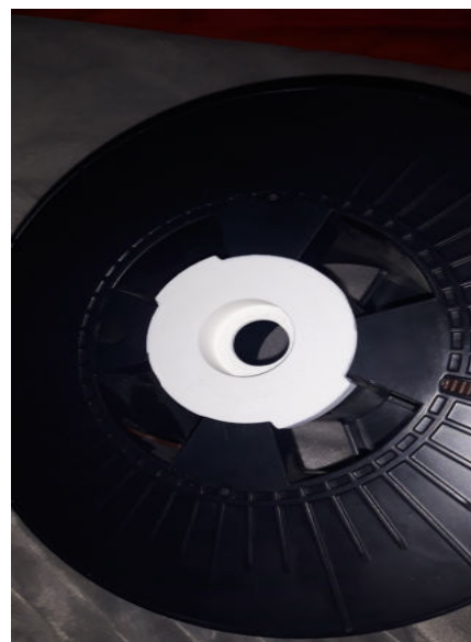
Εικόνα 73 : Βάση στήριξης άξονα με ρουλεμάν για την αποθήκευση του αναλώσιμου υλικού στο καρούλι.
