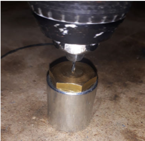
Εικόνα 69 : Δημιουργία τρύπας στο μπεκ της κεφαλής, με διάμετρο οπής 1,75 mm.
