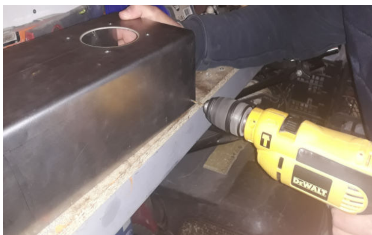
Εικόνα 64 : Δημιουργήθηκαν οπές όπου απαιτούνταν ώστε να στηριχτούν και να βιδώσουν όλα τα εξαρτήματα.
