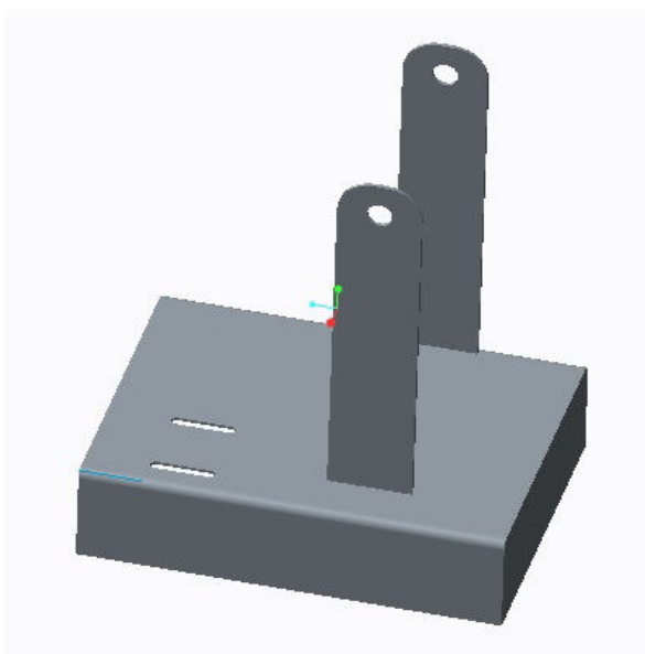
Βασικό σώμα – πλαίσιο συσκευής αποθήκευσης πλαστικού νήματος,σε διαστάσεις 150*200*50.Υλικό κατασκευής,λαμαρίνα ST 37 και πάχος 1,5 mm.
