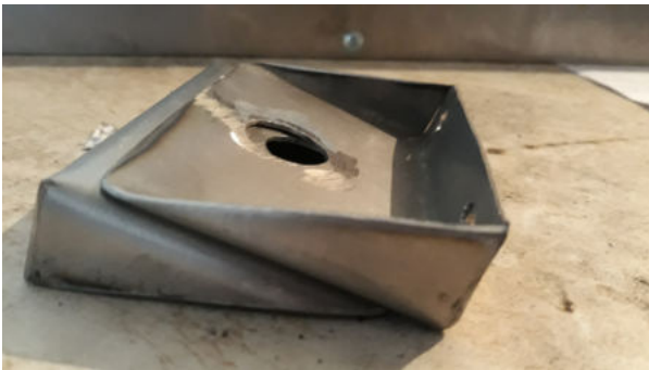
Εικόνα 66 : Κατασκευή βάσεων στήριξης της σωλήνας σε διαστάσεις,μήκος 100 mm και ύψος 60 mm.
