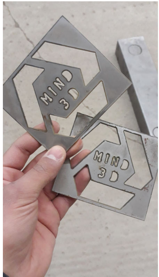
Εικόνα 76 : Κοπή λογότυπου σε λαμαρίνα ST 37 και πάχος 2 mm, σε διάσταση 100 * 90 mm.
