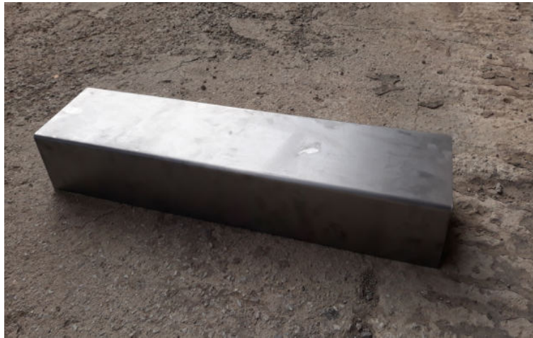
Εικόνα 62 : Κύριο σώμα – βάση όλων των εξαρτημάτων, κατασκευασμένο από ST 37 και πάχος 1,5 mm. Έγινε διαμόρφωση της γεωμετρίας με τη μέθοδο της στράντζας.
