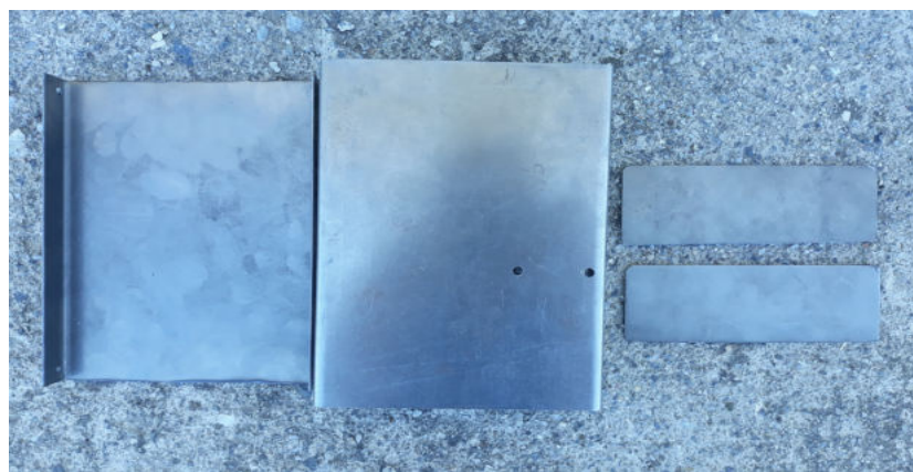
Εικόνα 70 : Κύριο σώμα – βάση όλων των εξαρτημάτων, κατασκευασμένο από ST 37 και πάχος 1,5 mm. Έγινε διαμόρφωση της γεωμετρίας με τη μέθοδο της στράνζας.
