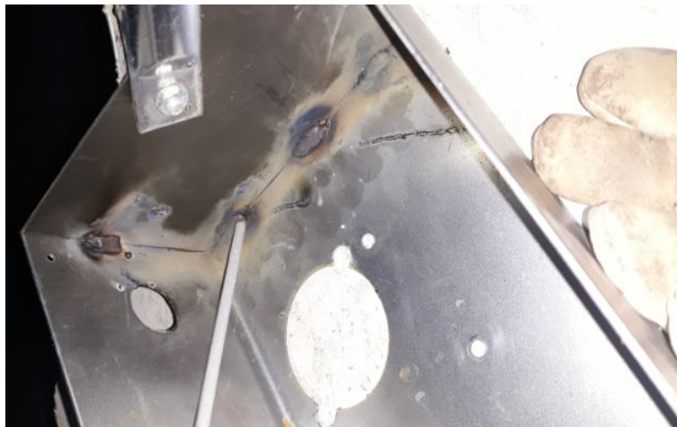
Εικόνα 63 : Στο αμέσως επόμενο βήμα κολλήθηκαν τα δύο πλαινά κομμάτια ώστε να μην υπάρχουν κενά και να γίνει πιο στιβαρή η βάση.
