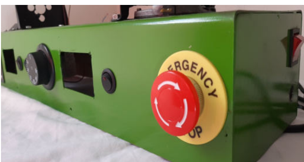
Εικόνα 82 : Τοποθέτηση μηχανικών και ηλεκτρικών εξαρτημάτων (ηλεκτροκινητήρα, βάσεων στήριξης, διακοπών, θερμοστάτη, emergency stop).
