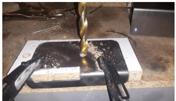
Εικόνα 67 : Κατασκευή βάσης στήριξης του κύριου ηλεκτροκινητήρα σε διαστάσεις,μήκος 130 mm και ύψος 75 mm.
