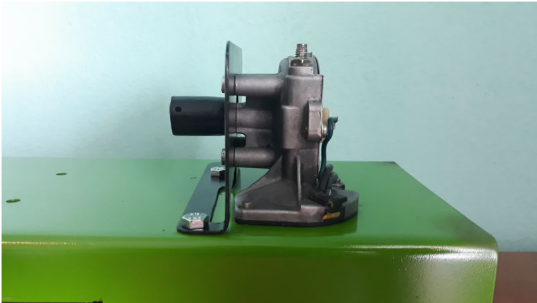
Εικόνα 80 : Τοποθέτηση βασικού ηλεκτροκινητήρα και βάση στήριξης.
