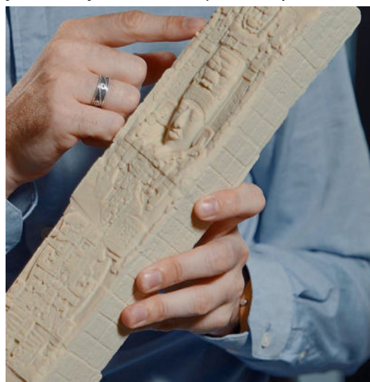
Εικόνα 26 - 27 : Πρόσθετο εκτυπωμένο κομμάτι σε προτομή. Εκτυπωμένο αρχαίο αντικείμενο εξ ολοκλήρου τρισδιάστατης εκτύπωσης. Με τη μέθοδο 3D scanning δημιουργήθηκαν τα τρισδιάστατα μοντέλα.
