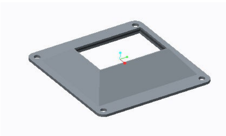
Εικόνα 35 : Αντάπτορας κατεύθυνσης του αέρα,σε διαστάσεις 80*80*17.Υλικό κατασκευής,PLA με τη μέθοδο της τρισδιάστατης εκτύπωσης.
