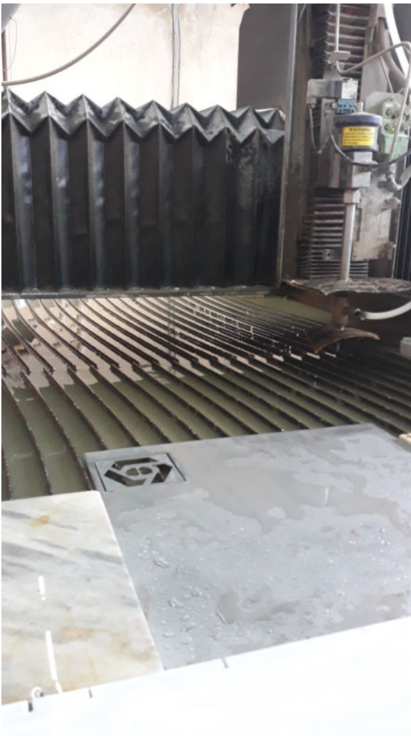
Εικόνα 76 : Κοπή λογότυπου σε λαμαρίνα ST 37 και πάχος 2 mm, σε διάσταση 100 * 90 mm.
