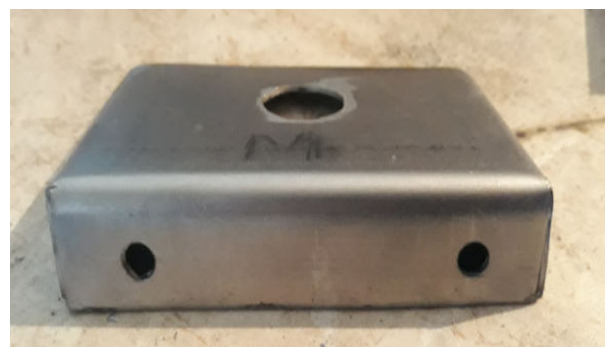
Εικόνα 66 : Κατασκευή βάσεων στήριξης της σωλήνας σε διαστάσεις,μήκος 100 mm και ύψος 60 mm.
