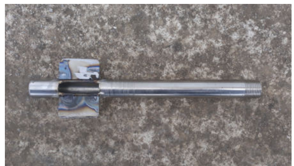
Εικόνα 68 : Κοπή σωλήνας για την τροφοδοσία του πλαστικού υλικού. Διαστάσεις αυλακιού 40 * 10 mm.Κόλληση δύο στηριγμάτων για το δοχείο τροφοδοσίας.
