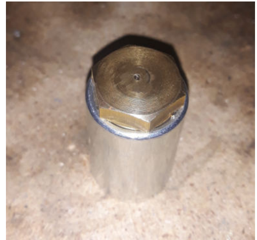
Εικόνα 69 : Δημιουργία τρύπας στο μπεκ της κεφαλής, με διάμετρο οπής 1,75 mm.
