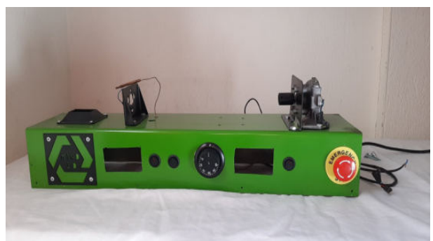
Εικόνα 82 : Τοποθέτηση μηχανικών και ηλεκτρικών εξαρτημάτων (ηλεκτροκινητήρα, βάσεων στήριξης, διακοπών, θερμοστάτη, emergency stop).
