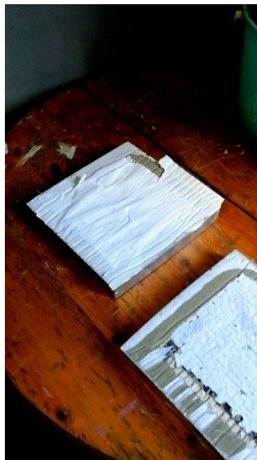
Εικ. 7.8.1.2: Αφαίρεση χαρτιού με γυμνό χέρι
