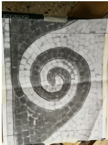
Εικ. 8.1.2: Τοποθέτηση και αντιγραφή σχεδίου πάνω στο ξύλο
