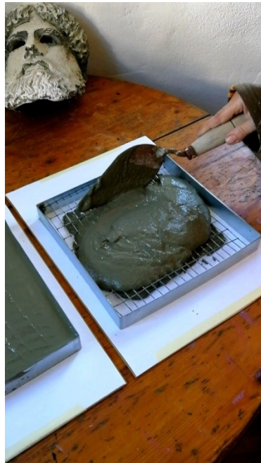
Εικ. 7.7.1.12: Τοποθέτηση υπόλοιπου κονιάματος
