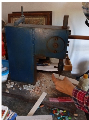
Εικ. 7.3.1.2.: Κοπή ψηφίδων σε σταθερό κόφτη ψηφίδων
