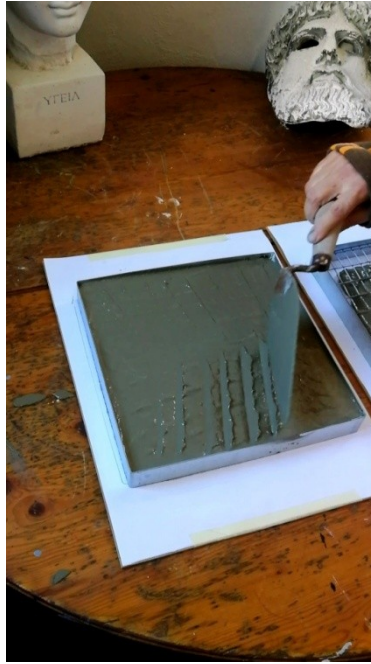
Εικ. 7.7.1.12: Με το μυστήρι ανακατεύονται τα κονιάματα
