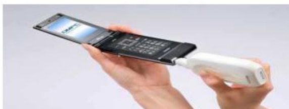
Σχήμα 2.18 : Κινητό τηλέφωνο με μπαταρία κυψέλης καυσίμου τροφοδοσίας μεθανόλης
