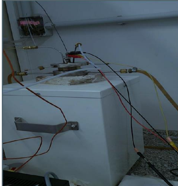
Σχήμα 3.4: Φούρνος που στο εσωτερικό του τοποθετείται ο αντιδραστήρας.
