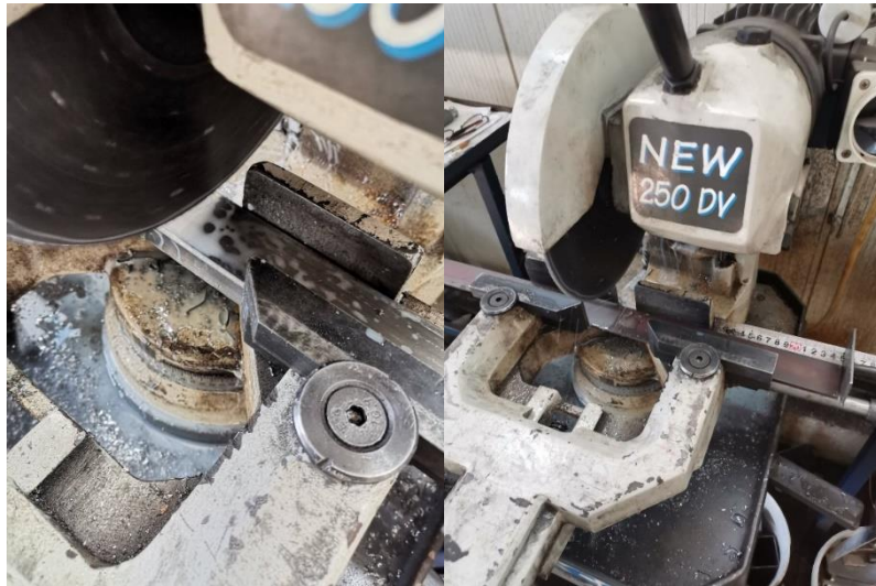
Εικόνα 4. 1 κοπή με τροχό των μεταλλικών βεργών
