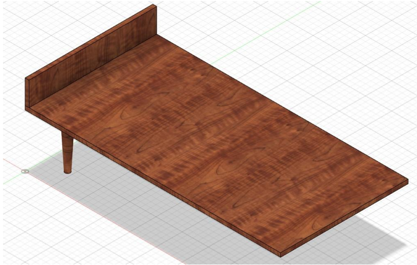
Εικόνα 22: Κάτω βάση, πόδι και πλαϊνή στήριξη τραπέζιού
