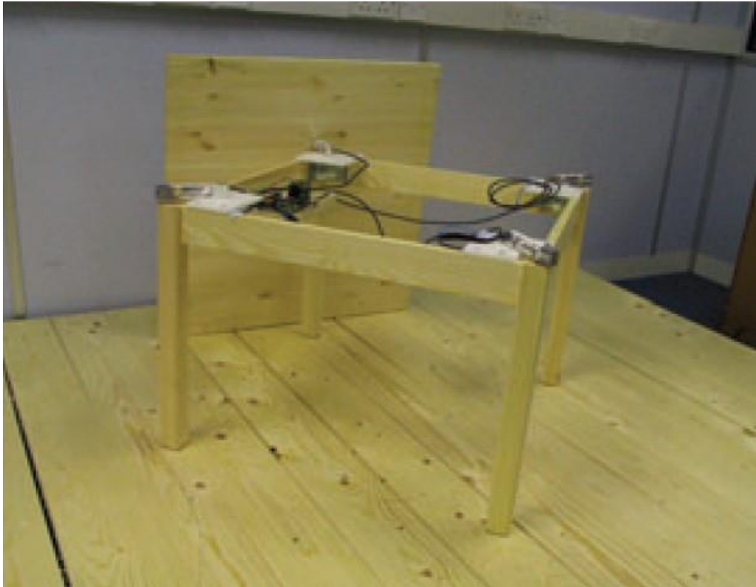
Εικόνα 7: Τραπέζι με ενσωματωμένους αισθητήρες στις γωνίες
