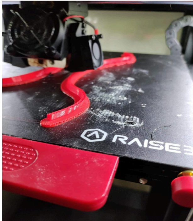
Εικόνα 5-3 Εκτύπωση πλάγιων φτερών α'
