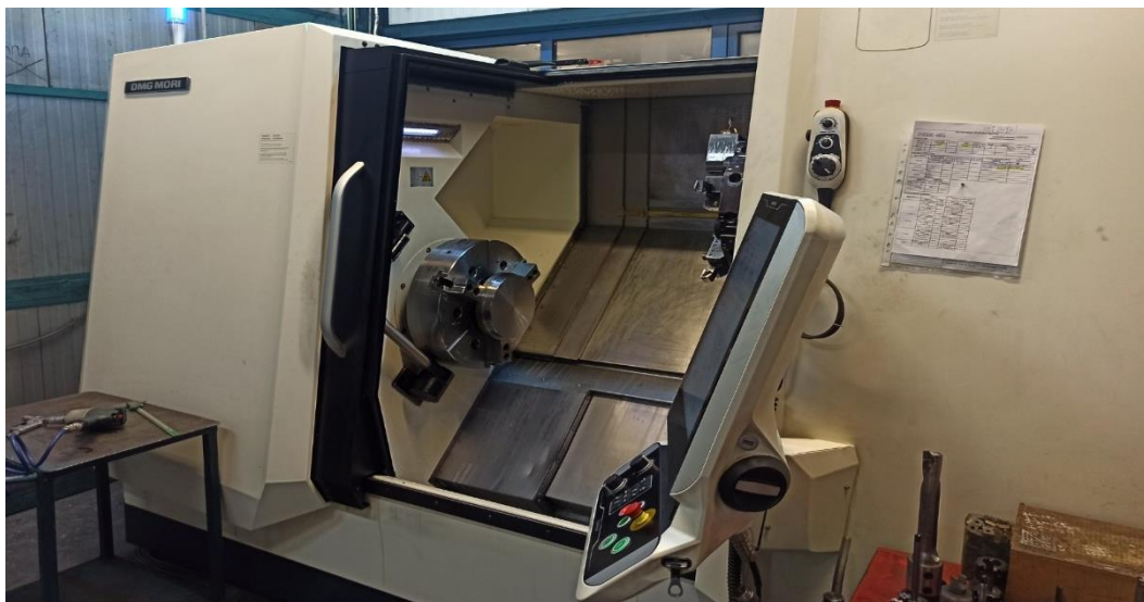
Εικόνα 20 Ο CNC dmg mori τórνος όπου πραγματοποιήθηκε η τórνευση του κομματιού
