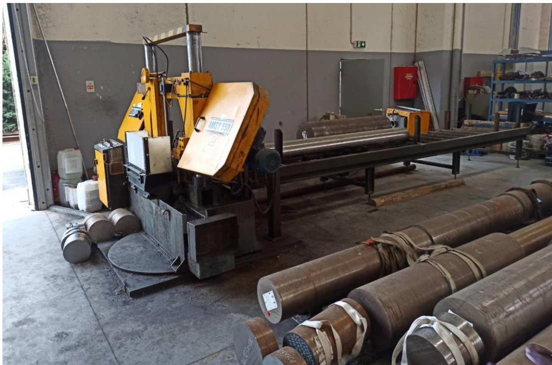
Εικόνα 17 Πριονοκορδέλα στην οποία έγινε η κοπή
