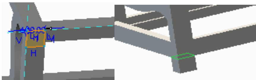
Εικόνα 6. 17 εξώθηση όγκου με τις εντολές sketch και extrude
